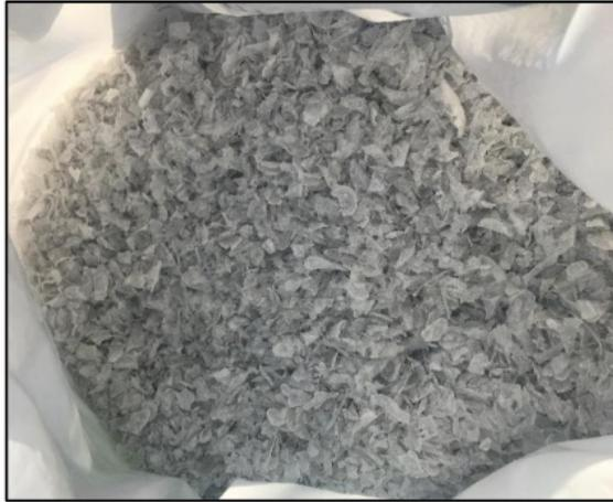
Figura 4: Agregado de tereftalato de polietileno.
