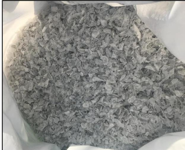
Figura 10: Agregado de tereftalato de polietileno.
