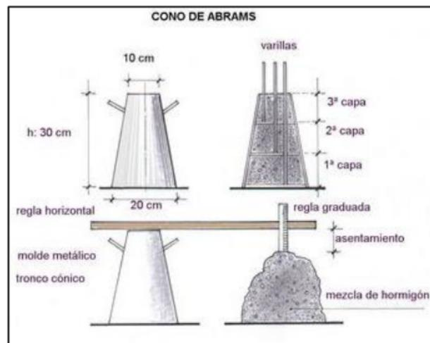
Figura 7: Asentamiento del concreto.
