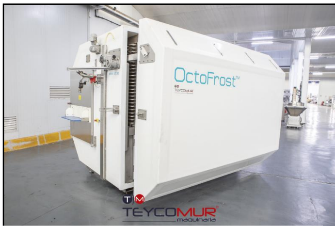
Figura 46: Congelador IQF de la marca Octofrost. Fuente: Elaboración Propia
