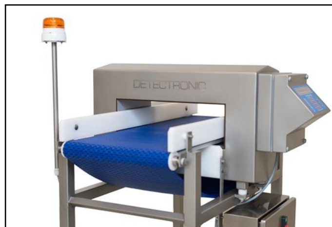
Figura 44: Detector de metales al final del envasado primario. Fuente: Elaboración Propia
