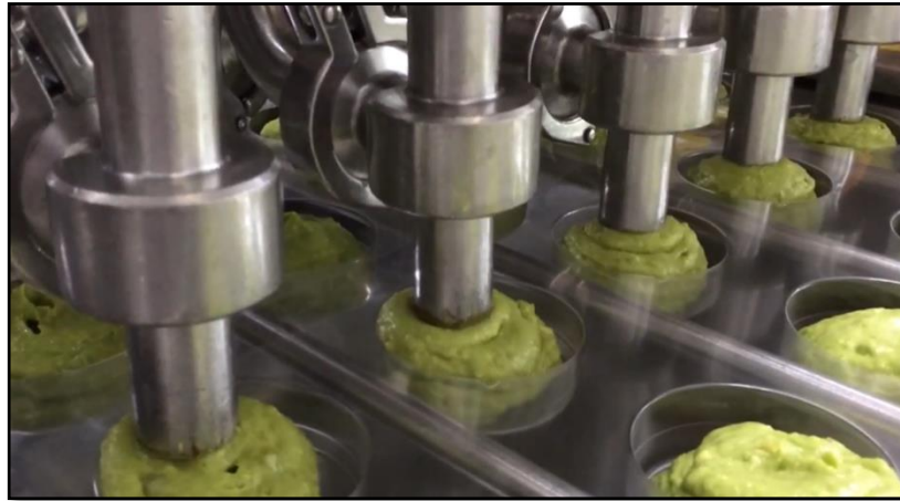
Figura 43: Llenadora de precisión americana HINDS BOCK. Fuente: Elaboración Propia
