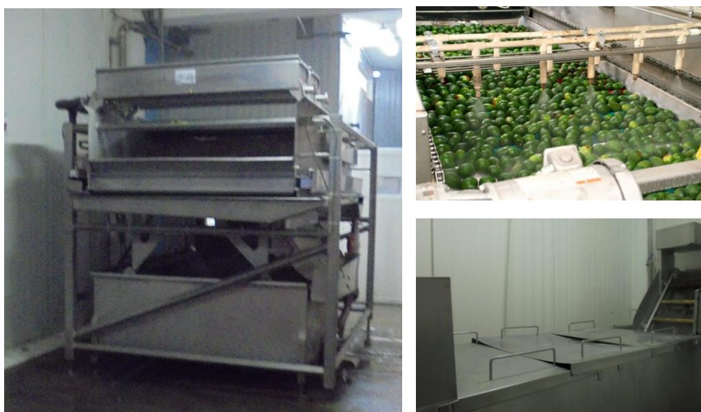
Figura 37: Partes de una línea de lavado (cepillado, Stein, enfriamiento y desinfección). Fuente: Elaboración Propia
