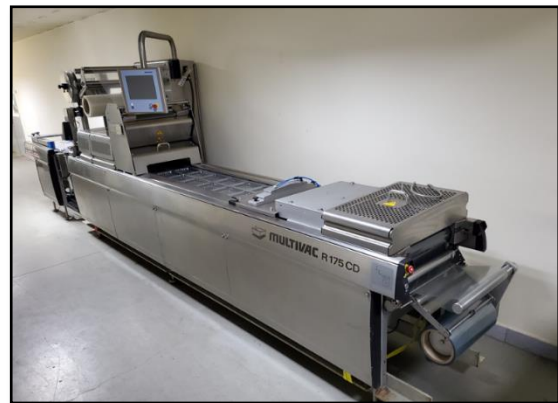
Figura 42: Envasadora de producto en taper plástico Alemana Multivac. Fuente: Elaboración Propia
