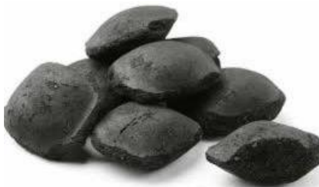
Figura 49: Briquetas de carbón vegetal a partir de desperdicios industriales (cáscara y pepa). Fuente: Elaboración Propia
