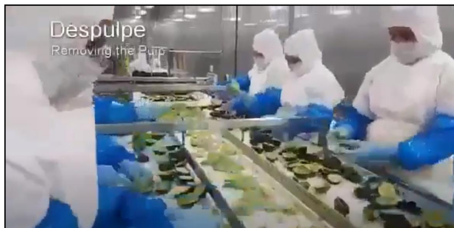
Figura 39: Fajas continuas para despulpe Fuente: Elaboración Propia
