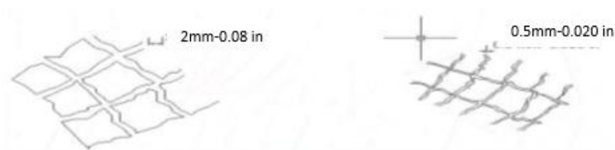
Figura 8. Medida de abertura de junta.
