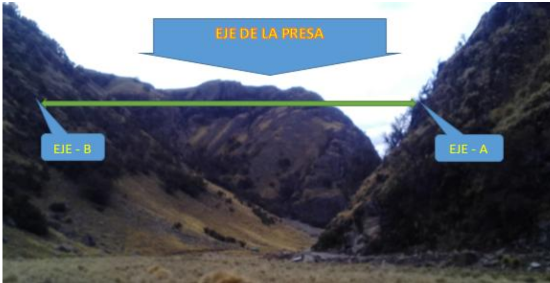
Figura 30. Ubicación del eje de la presa.
