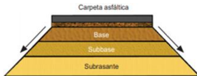
Figura 16: Estructura de pavimento flexible
