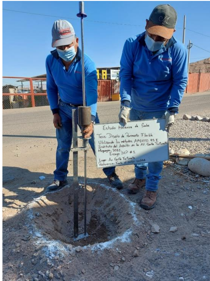
Fotografía 1. Punto 1 ensayo normal para el uso del D.C.P. en aplicaciones de pavimentos a poca profundidad ASTM 06951
