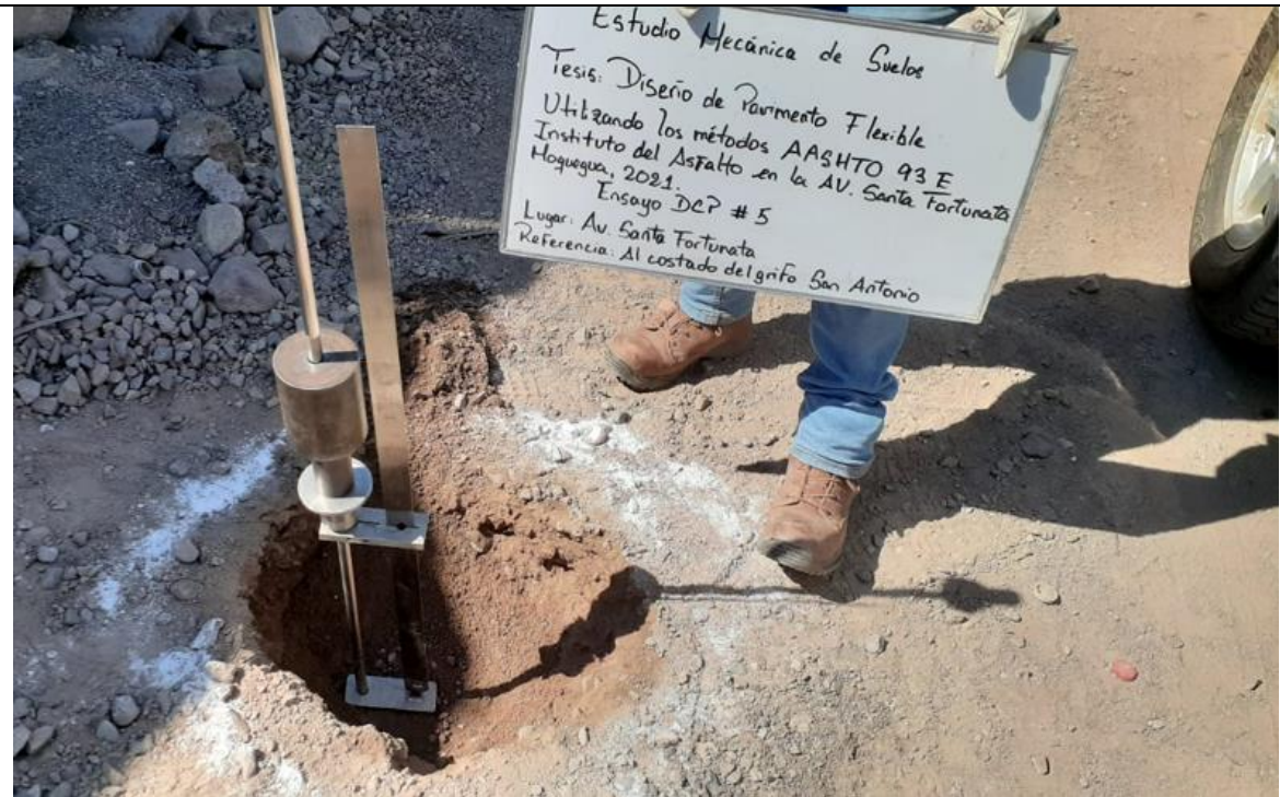
Fotografía 5. Punto 5 ensayo normal para el uso del D.C.P. en aplicaciones de pavimentos a poca profundidad ASTM 06951
