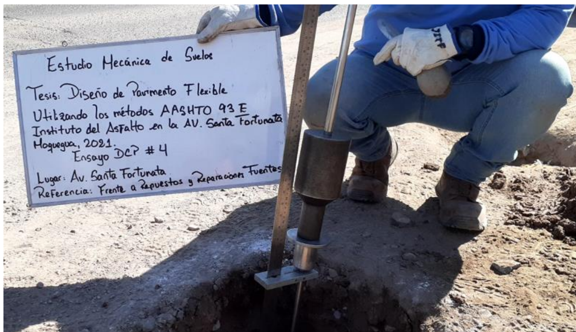
Fotografía 4. Punto 4 ensayo normal para el uso del D.C.P. en aplicaciones de pavimentos a poca profundidad ASTM 06951.
