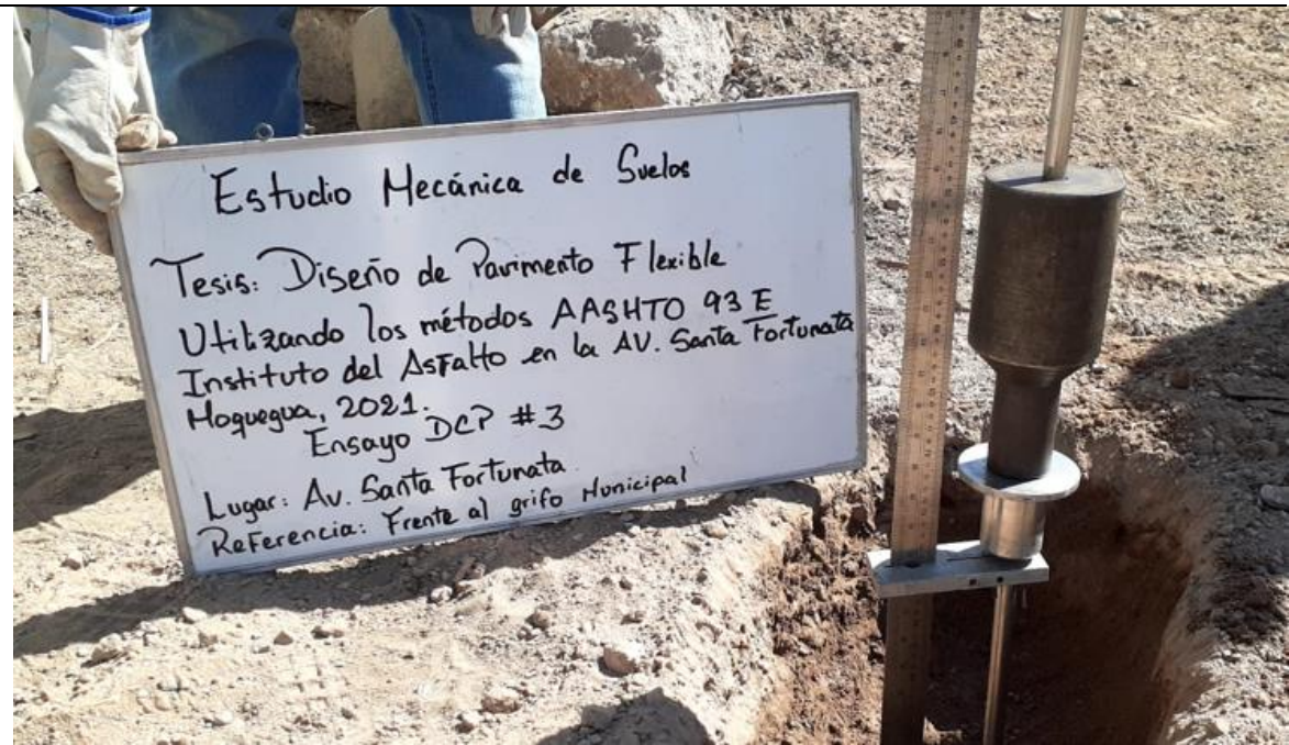
Fotografía 3. Punto 3 ensayo normal para el uso del D.C.P. en aplicaciones de pavimentos a poca profundidad ASTM 06951
