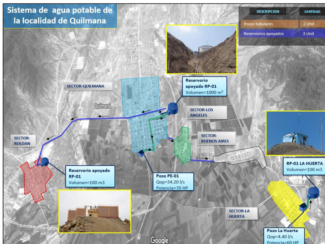
Figura 8 Sistema de abastecimiento de Agua Potable en Quilmana
