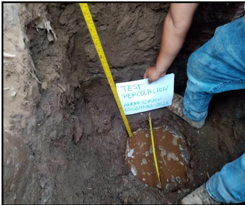
Figura 12 Vista del proceso del TEST DE PERCOLACION
