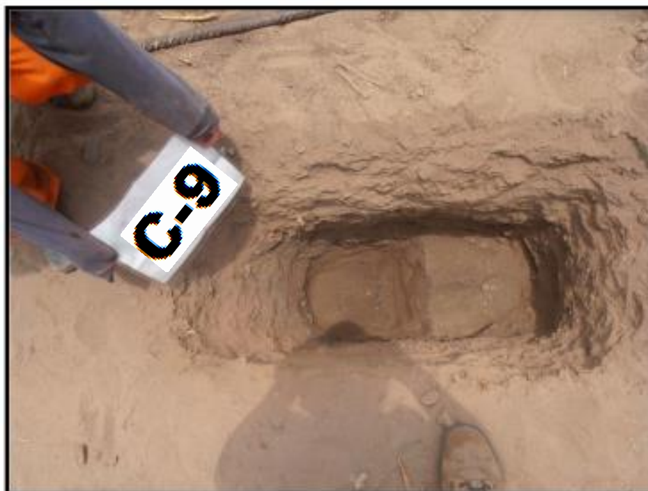
Figura 8 Vista de los Estratos en la Calicata N° 9
