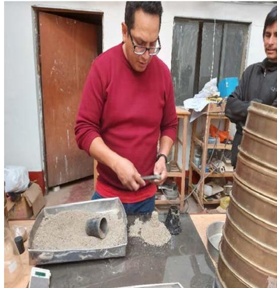
**FIGURA 14:** Ensayo de absorción y Gravedad específica del agregado fino.
