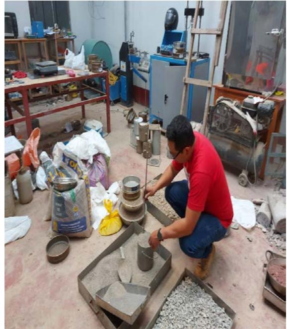
**FIGURA 18:** Ensayo de peso unitario Compactado del agregado fino.
