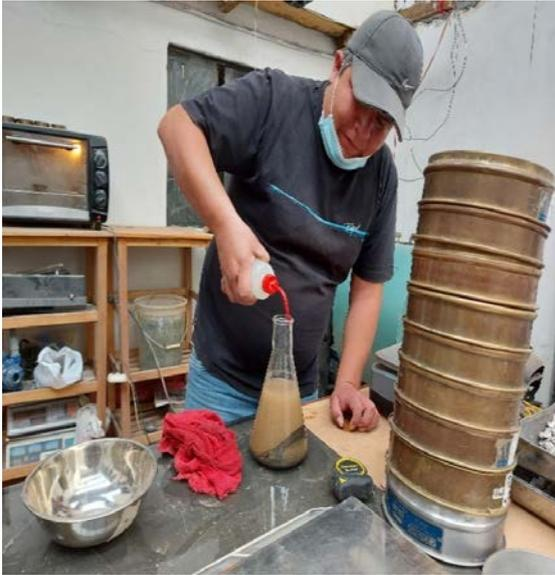
**FIGURA 13:** Ensayo Peso específico del Agregado fino.
