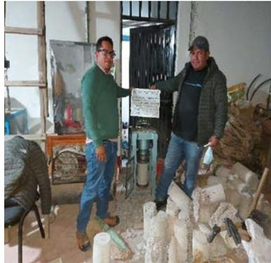
**FIGURA 22:** Rotura testigo De concreto 21 días.
