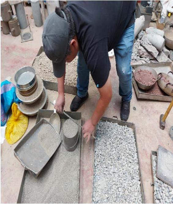
**FIGURA 17:** Ensayo de peso unitario Suelto de agregado fino.
