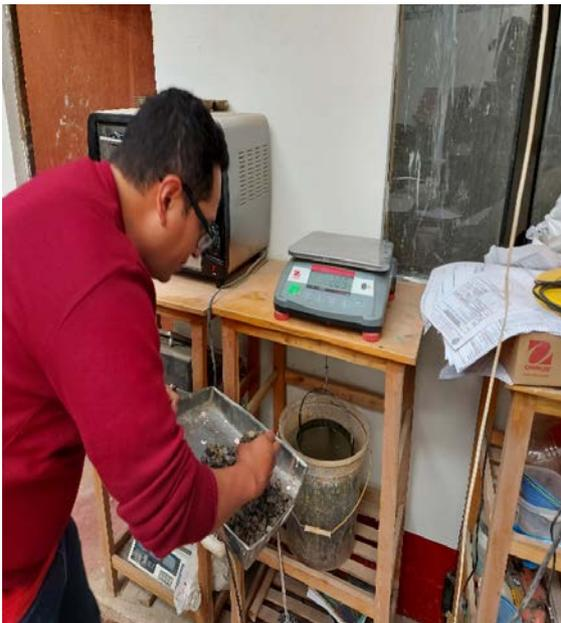
**FIGURA 15:** Ensayo Peso del agregado Grueso saturado.
