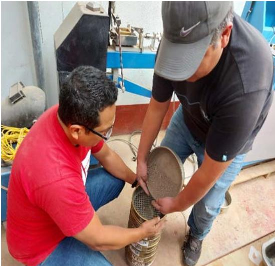
**FIGURA 11:** Ensayo Análisis Granulomet. Agregado fino.
