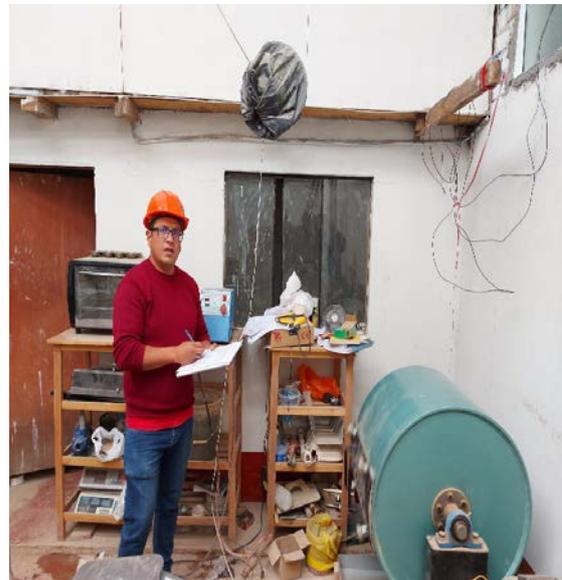
**FIGURA 08:** Ensayo de abrasión (Los Ángeles).
