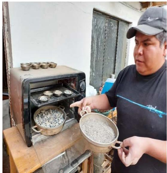
**FIGURA 10:** Ensayo de Contenido de Humedad A.F y A.G.
