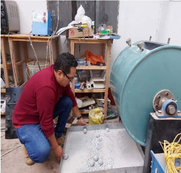
**FIGURA 9:** Degradación de concreto Reciclado como agregado grueso.
