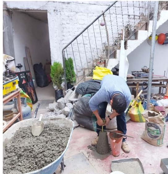
**FIGURA 20:** Trabajabilidad del concreto (Ensayo cono Abrams)
