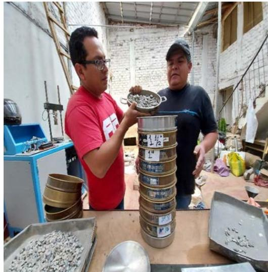
**FIGURA 12:** Ensayo Análisis Granulomet. Agregado grueso.
