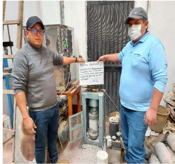
**FIGURA 22:** Rotura de testigo de concreto 7 días.
