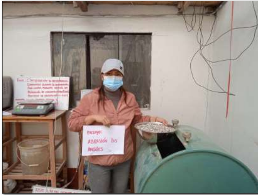
Foto N° 11 Muestra el ensayo de abrasión los ángeles.
