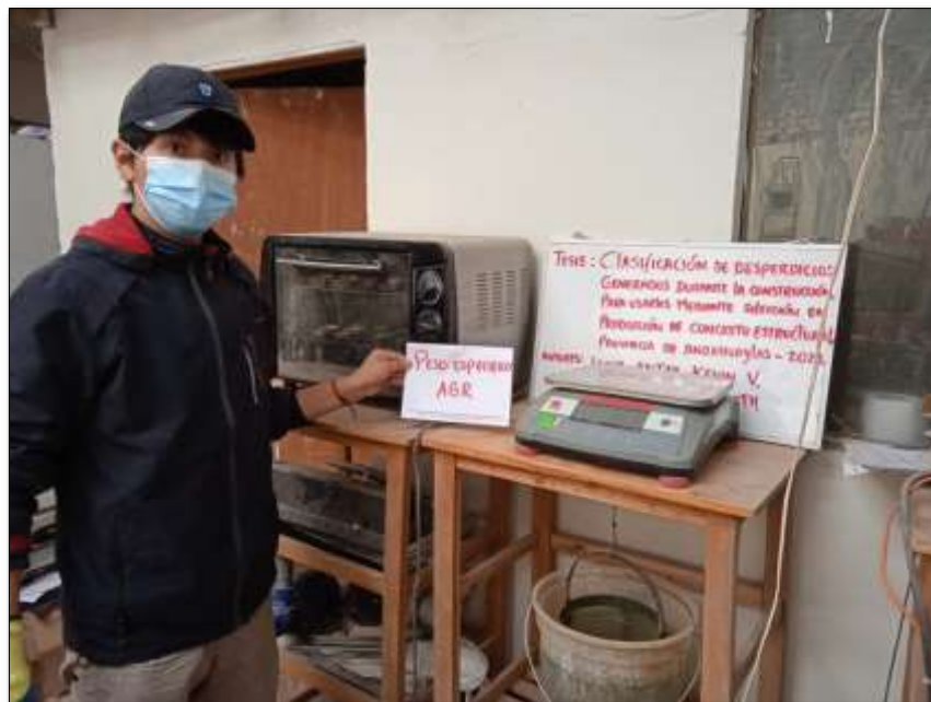
Foto N° 10 Muestra el ensayo de peso específico al agregado grueso.
