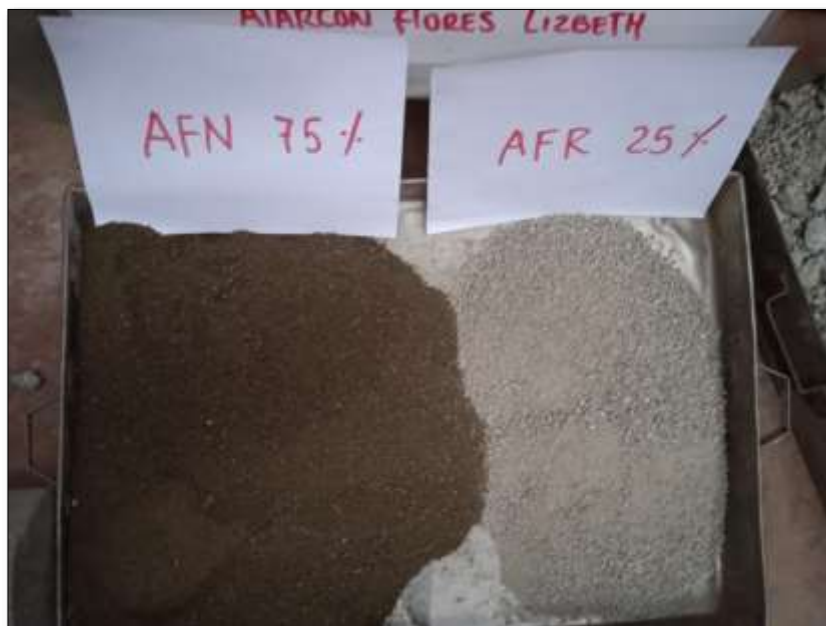
Foto N° 06 Muestra de agregado fino de cantera y agregado fino reciclado.
