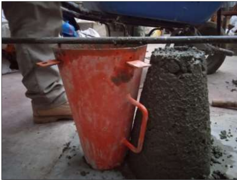
Foto N° 14 Muestra el ensayo de SLUMP.
