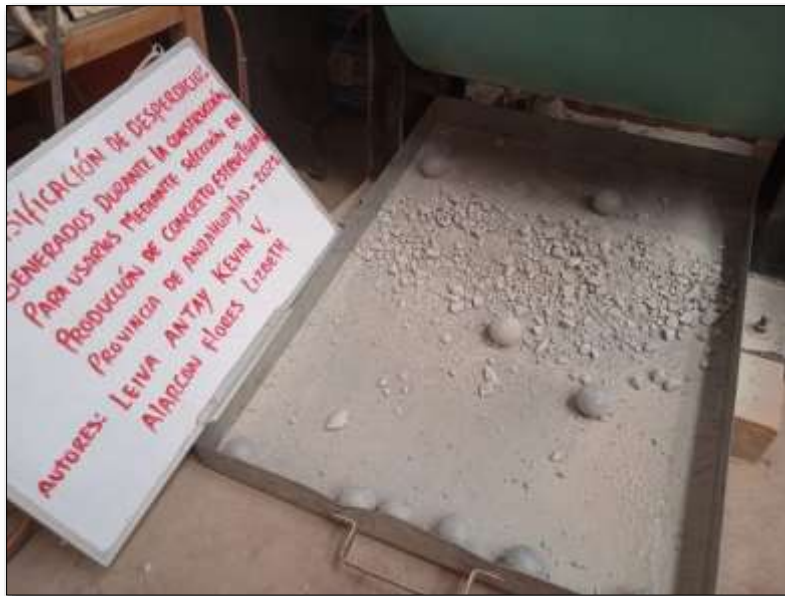
Foto N° 12 Muestra el ensayo de abrasión los ángeles.
