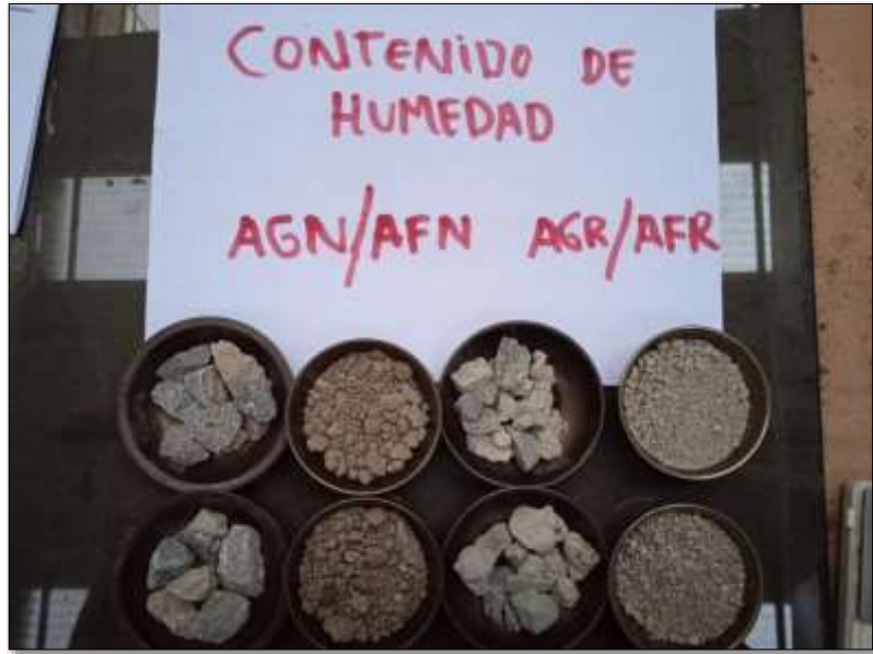
Foto N° 07 Muestra el ensayo de contenido de humedad.
