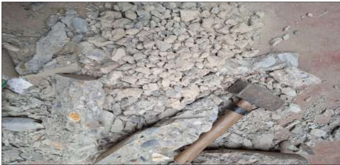
Foto N° 04 Muestra del concreto de residuos de construcción triturado.
