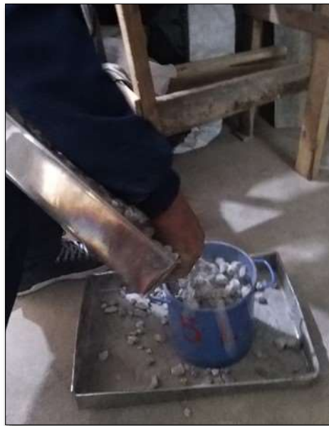
Foto N° 08 Muestra el ensayo de peso unitario del agregado grueso.
