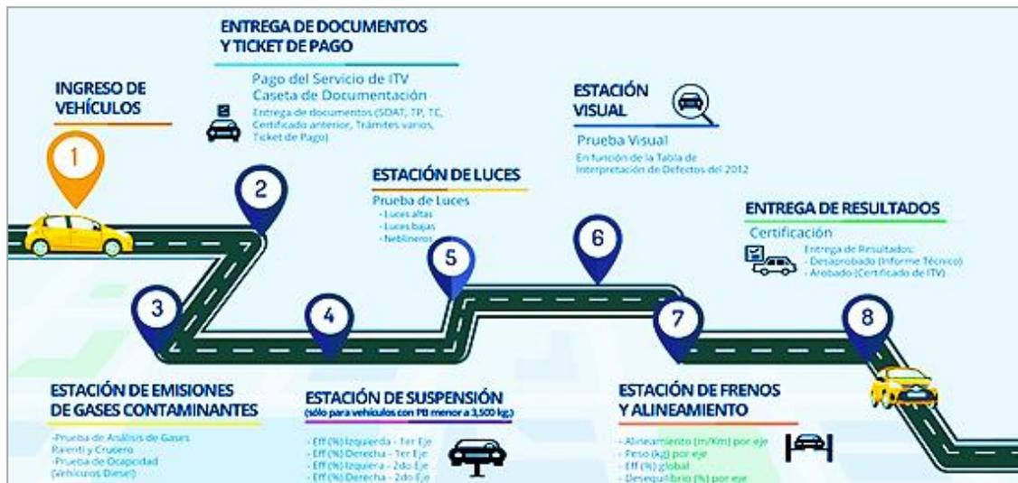
**Figura 3:** Proceso de revisión técnica vehicular
