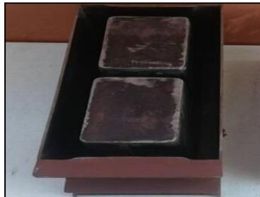
Figura 5 Molde de bloque de 15x19x40 albañilería armada.
