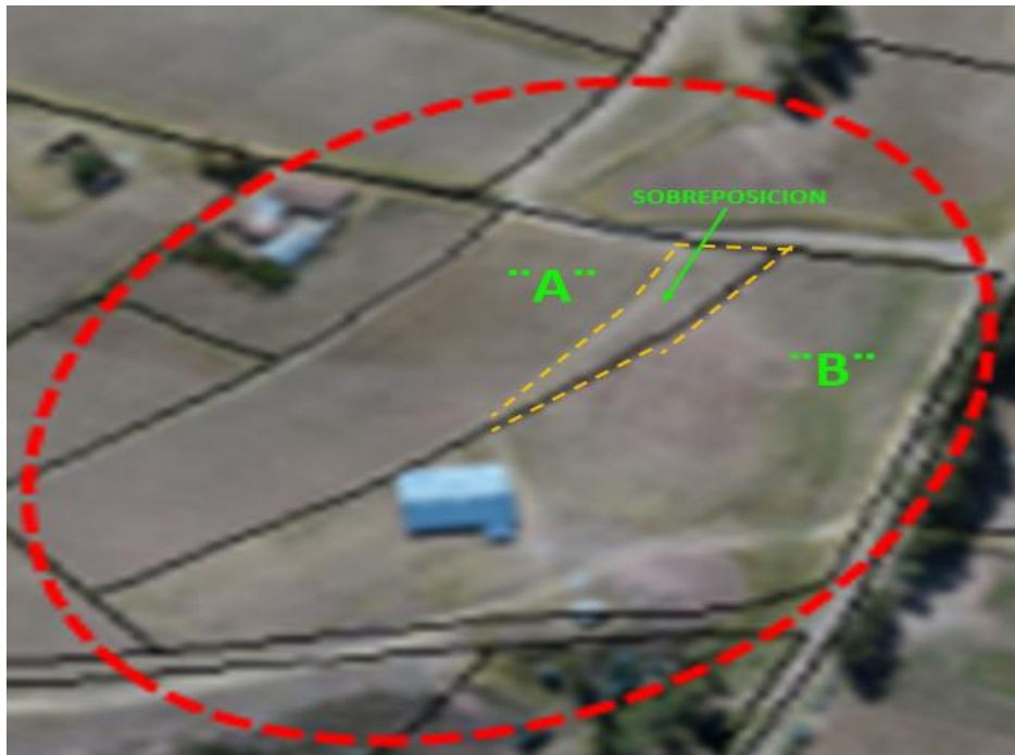
Figura 4: La parcela "A" y "B", tienen sobre posición de territorio con el cementerio.
