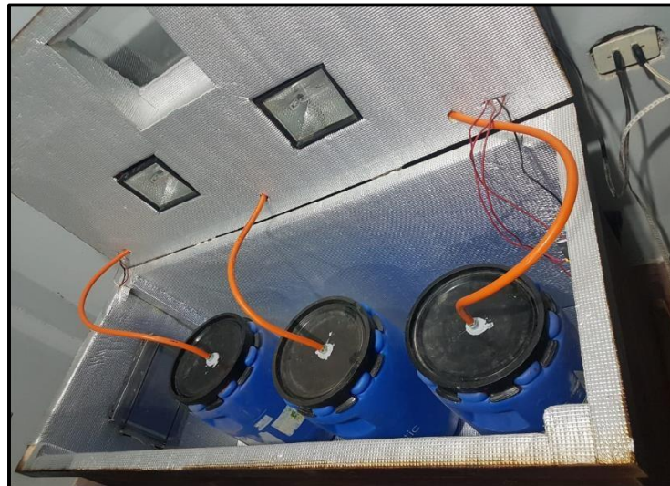
Figura N° 8: Representación de la ubicación de los biodigestores tipo batch en la incubadora.
