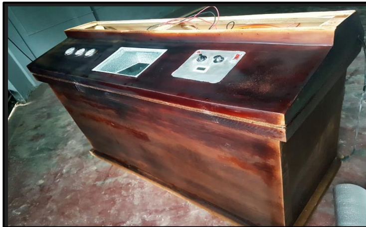
Figura N° 10: Representación de la ubicación de los instrumentos para el control de T^\circ y P .
