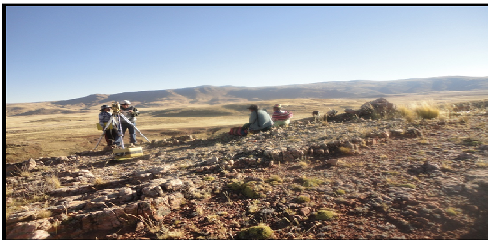
Figura 5. Levantamiento topográfico de la línea de conducción
