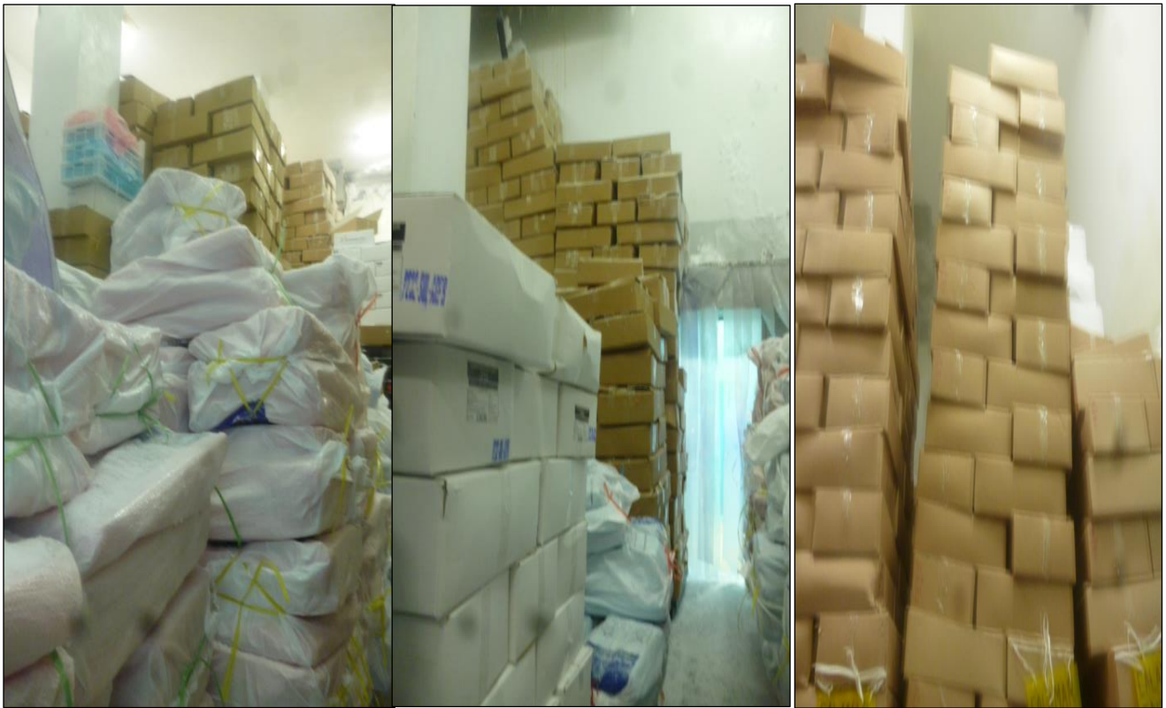
Cantidad de Cajas Estibadas a alturas inadecuadas, ausencia de pasillos para el manejo de equipos.
