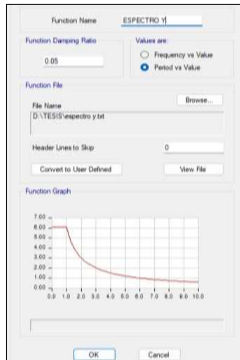
Figura 19. Incorporación del Espectro de respuesta Y-Y, Etabs v.19
