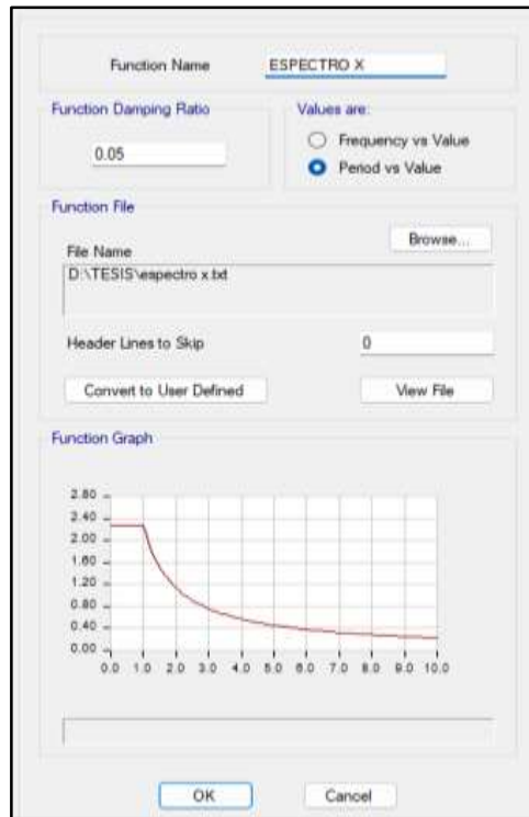
Figura 18. Incorporación del Espectro de respuesta X-X, Etabs v.19
