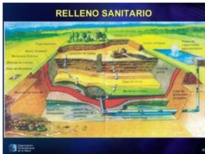
Figura 1: Componentes de un relleno sanitario. Tomado de: Organización Panamericana de la Salud (2017).
