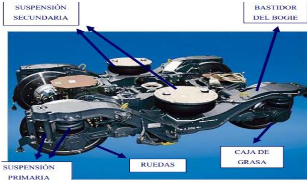
**Figura 5.** El bogie aquel par montado de ruedas, sobre el cual se apoya la carrocería, el grafico es extraído de Fuente: Alvarez Castillo, I. (2018)
