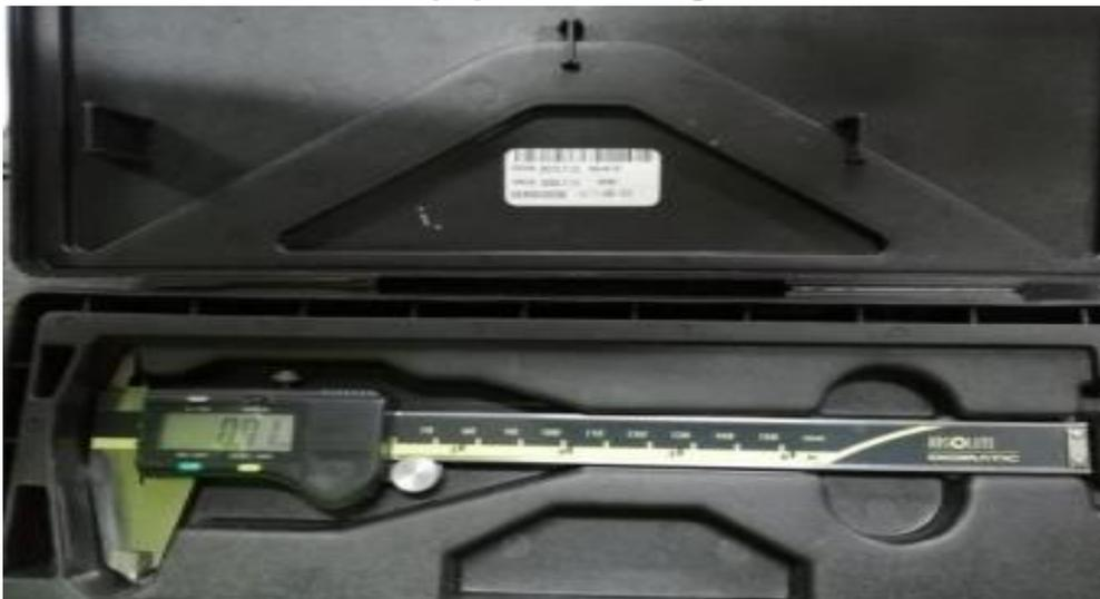
**Figura 17.** Equipo utilizado para medir el desgaste de la pastilla y disco de freno
