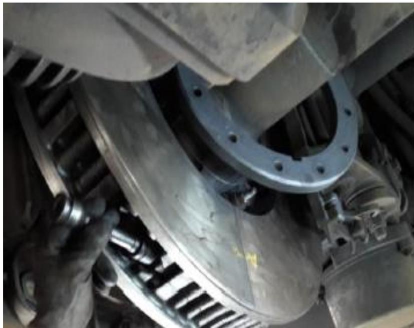
**Figura 13.** Instalación disco de freno bipartido, sin necesidad de retirar las ruedas
