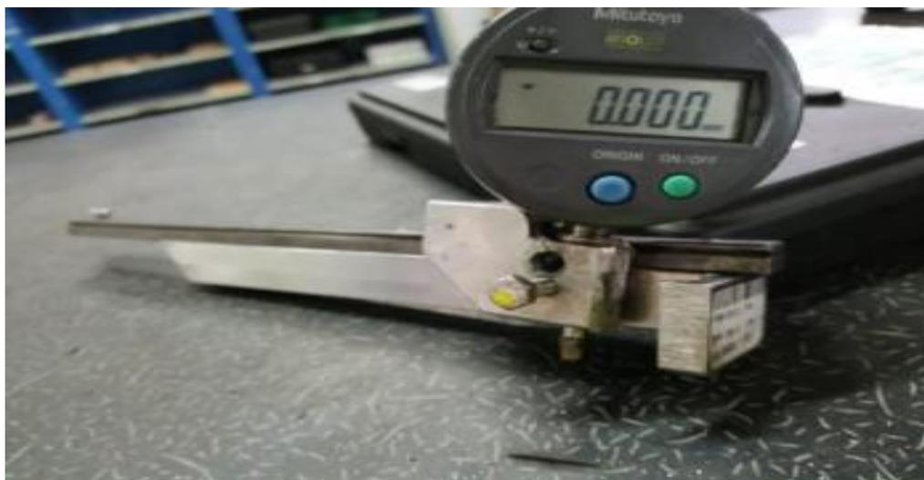
**Figura 15.** Verificar el alabeo girando el disco manualmente palpando con el reloj comparador las superficies del disco
