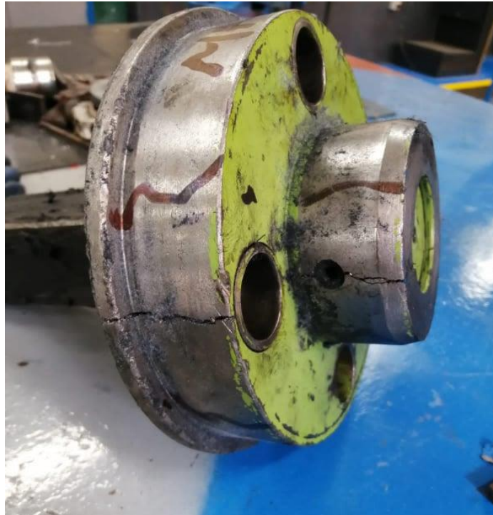
Rotura de acople por desgaste de eje
