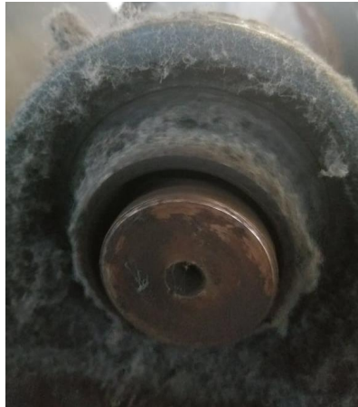
Figura 22: Desgaste de ejes acumulados
