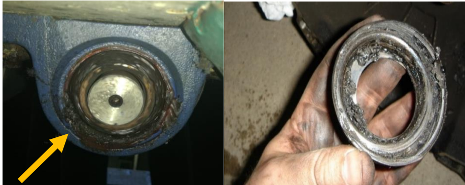
Figura 13: Rodamientos en mal estado
