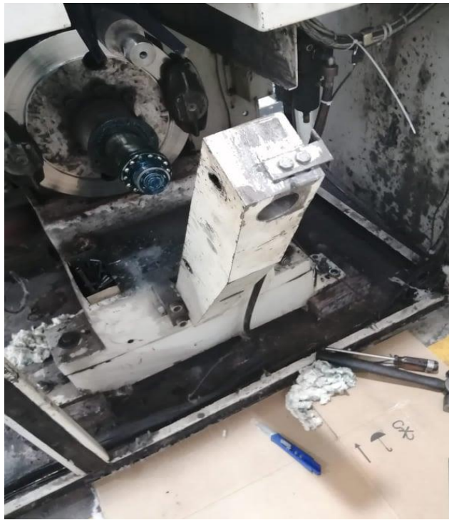
Rotura del soporte
