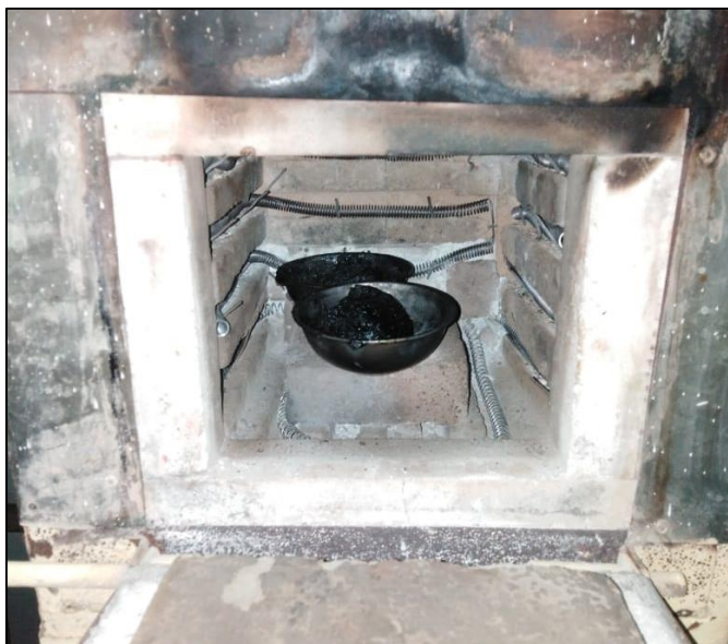
Figura 21 Activación química de la valva de caracol africano.
