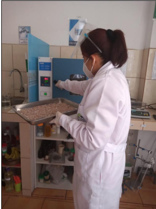
Fuente: Elaboración propia Figura 16 Secado de los caracoles africanos en un horno.
