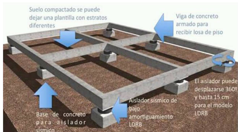
Figura 13: Partes de un edificio aislado sísmicamente
