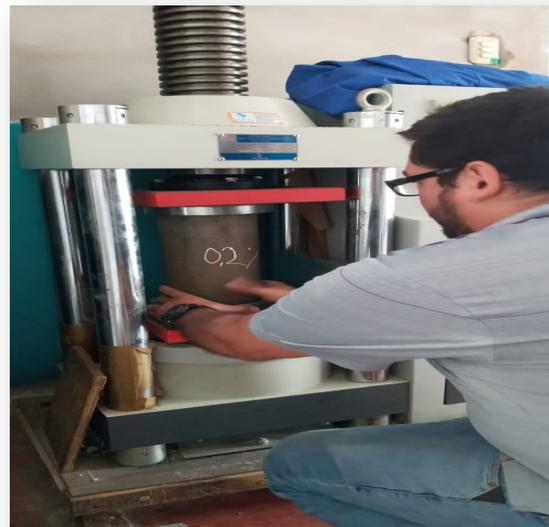
Probeta en la prensa para saber cuánto es su valor de resistencia a la compresión
