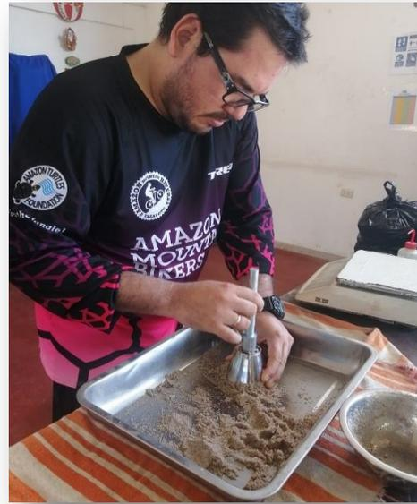
ensayo de punto óptimo de humedad
