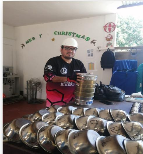
Ensayo de granulometría de agregado fino y grueso
