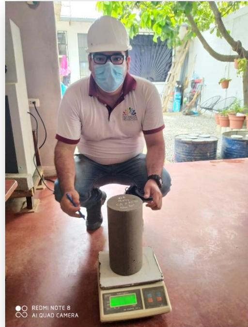
Curado de las probetas y posteriormente el pesado de estas para la ruptura
