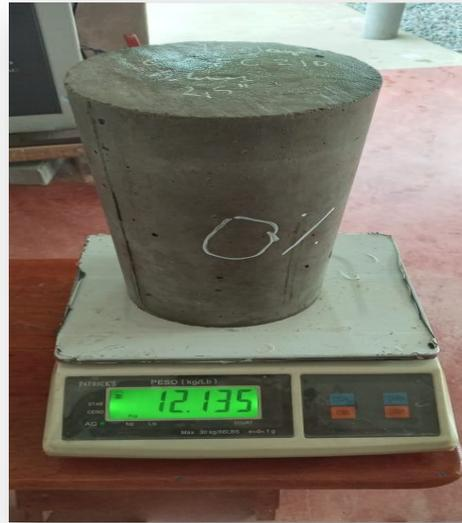
Pesado de las probetas antes de ser puestas en la prensa
