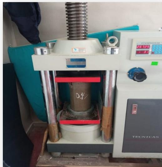
Colocado de las probetas en la prensa hidráulica para poder ver su resistencia a la compresión
