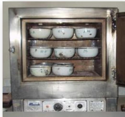
Peso de la muestra en canastilla sumergida y posteriormente secado en horno.
