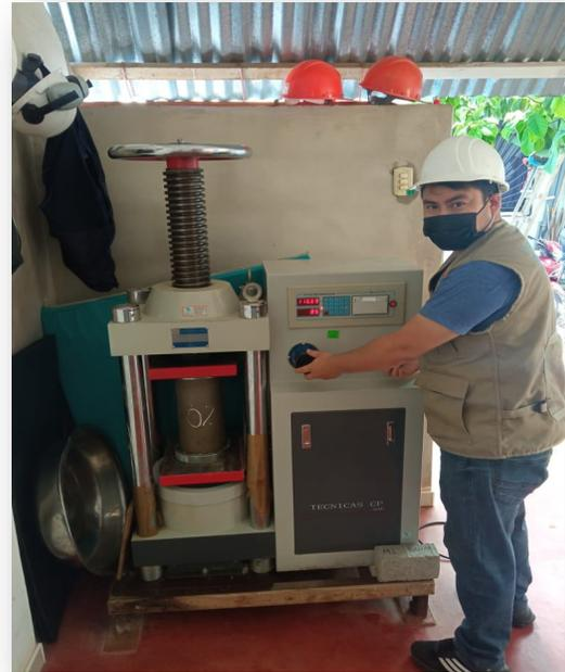
Proceso de ruptura de las probetas en la prensa hidráulica.
