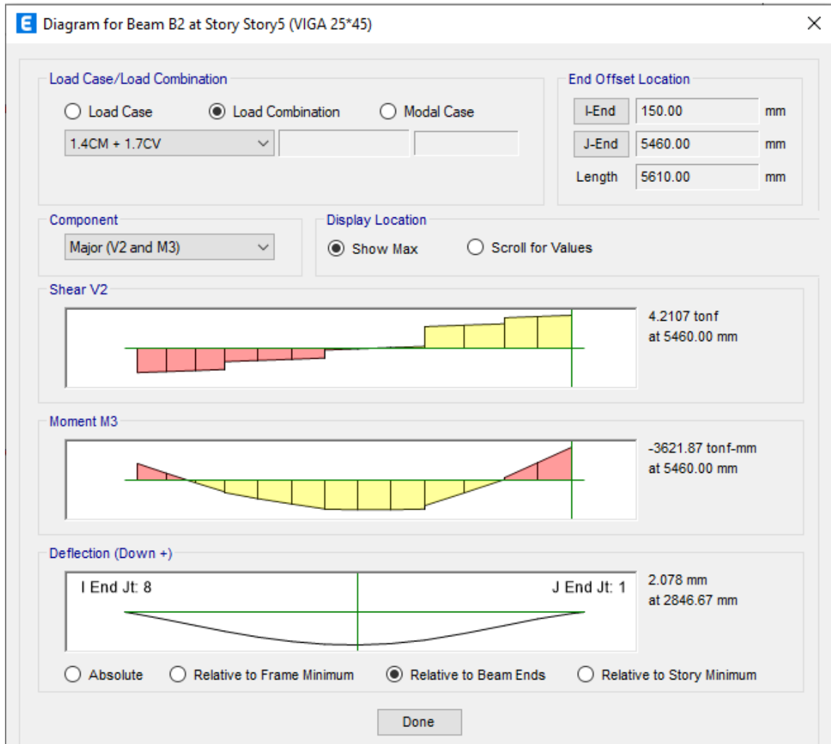
Ilustración 24: Momentos y cortantes en viguetas
