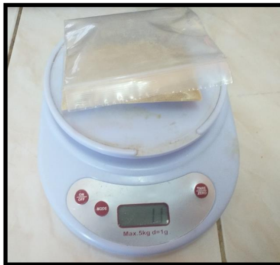
FIGURA N° 12 : se tomó 11 gr de tusa de maíz molida para el ensayo de Análisis térmico diferencial.
