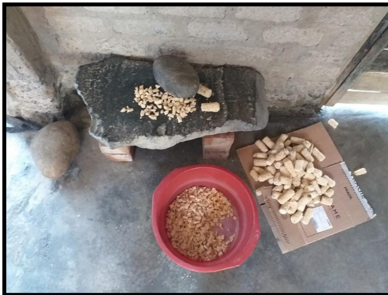
FIGURA N° 8 :Trituración de la tusa de maíz con un batan para reducir su tamaño
