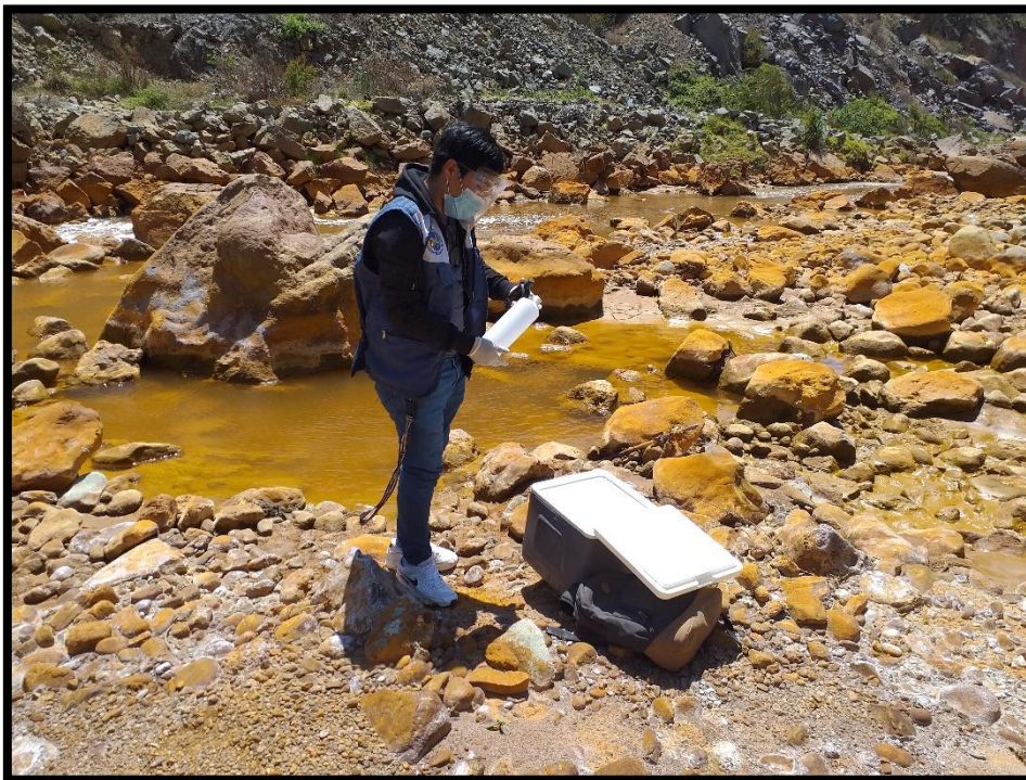
FIGURA N° 2 : toma de muestra para la realizar el ensayo de barrido de metales.
