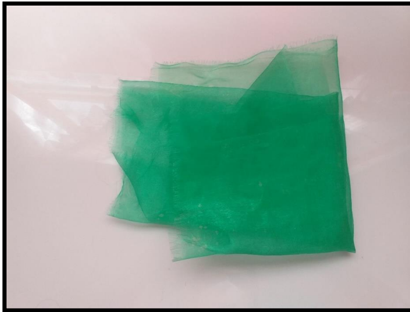
FIGURA N° 18 : Se utilizó la malla organza para el tamizado de las cenizas de tusa de maíz el cual se asemeja a la malla N.º 100
