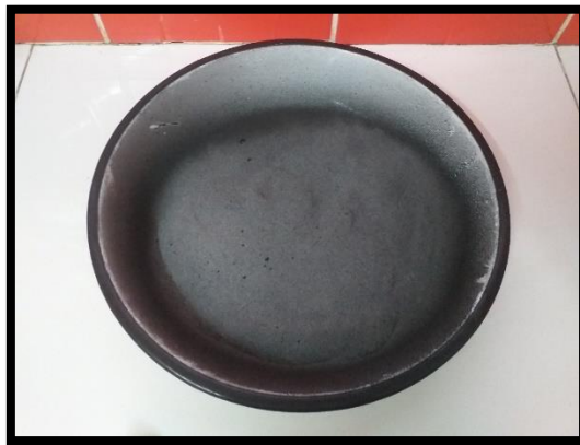
FIGURA N° 20 : las cenizas de tusa de maíz ya tamizada con la maya organza
