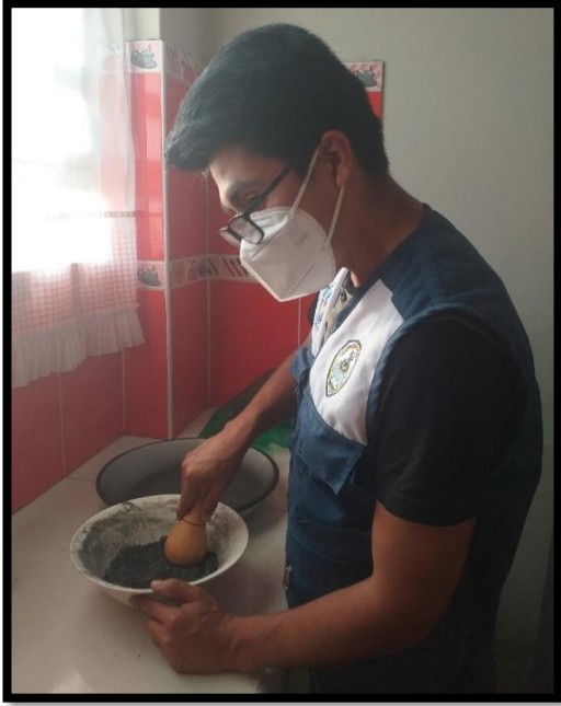
FIGURA N° 17 : pulverización de las cenizas de tusa de maíz con un mortero
