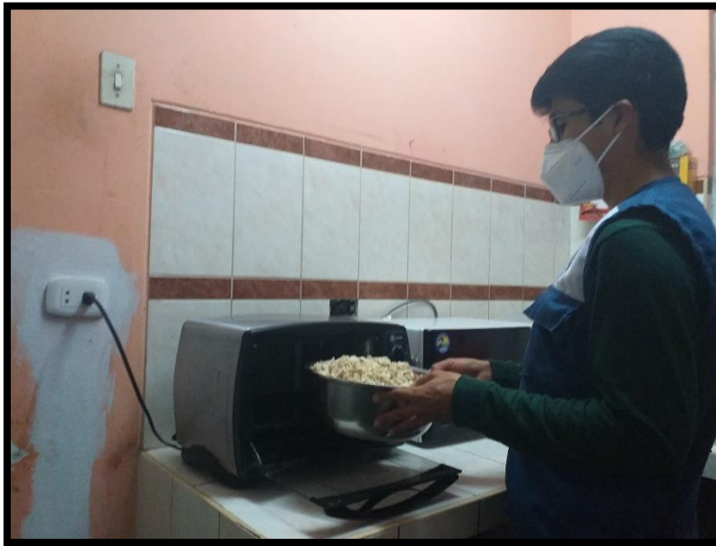
FIGURA N° 9 : secado de la tusa triturada mediante un horno casero a 110° C por 2 horas.
