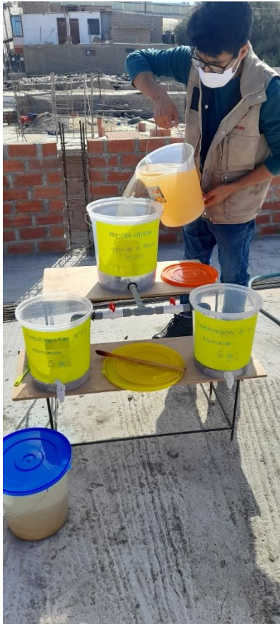
FIGURA N° 29 : realización de los experimentos para la remoción de plomo mediante un prototipo de biofiltro a base de cenizas de tusa de maíz.
