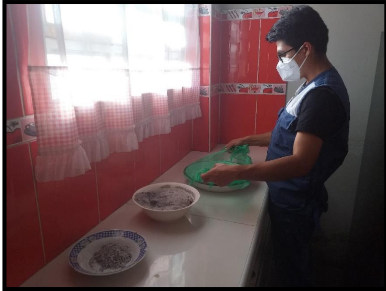
FIGURA N° 19 : la ceniza de tuza de maíz siendo tamizada
