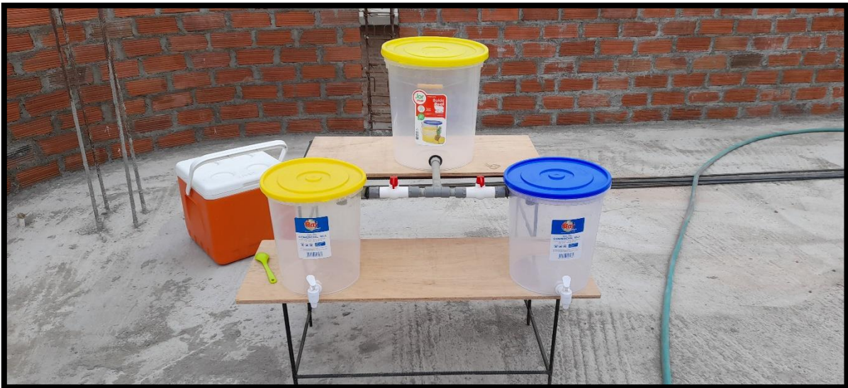
FIGURA N° 26 : prototipo de biofiltro terminado
