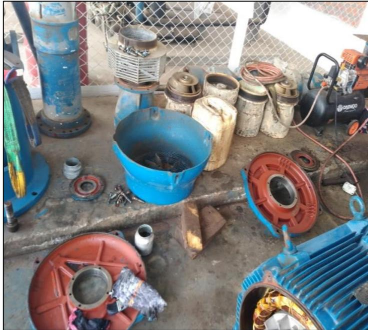
Desmontaje de partes de motor 150HP.
