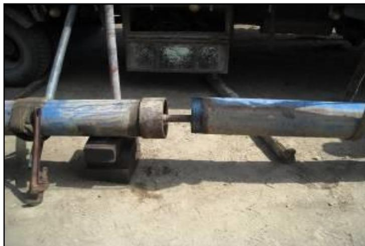
Desmontaje de bomba vertical.
