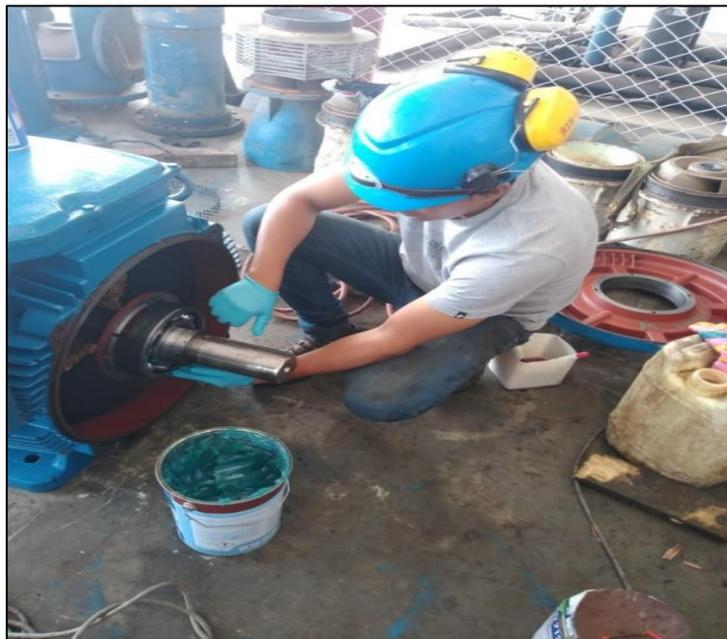
Lubricación del rodamiento del motor.
