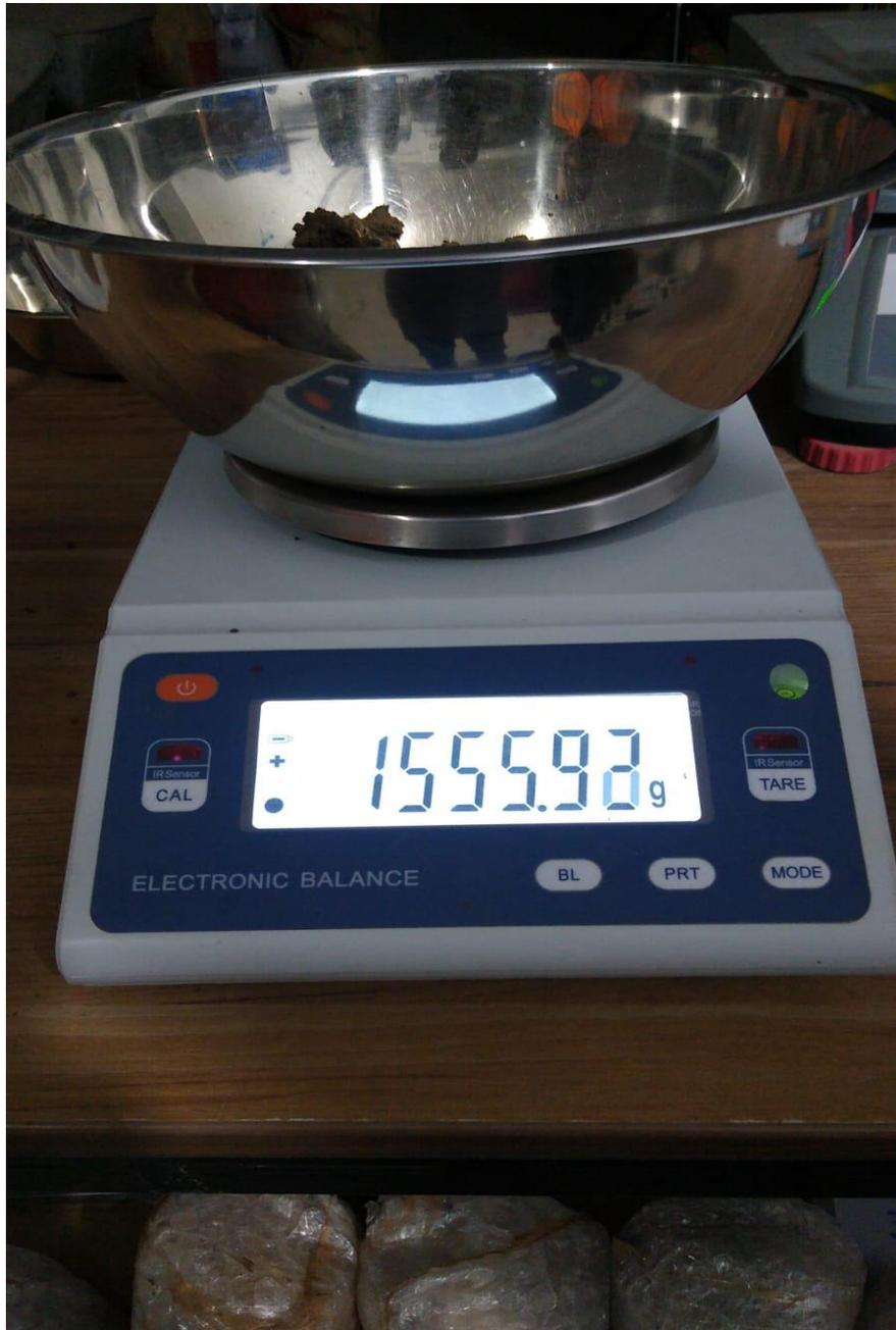
**FOTOGRAFÍA N° 04: ENSAYO DE PESO VOLUMÉTRICO**
