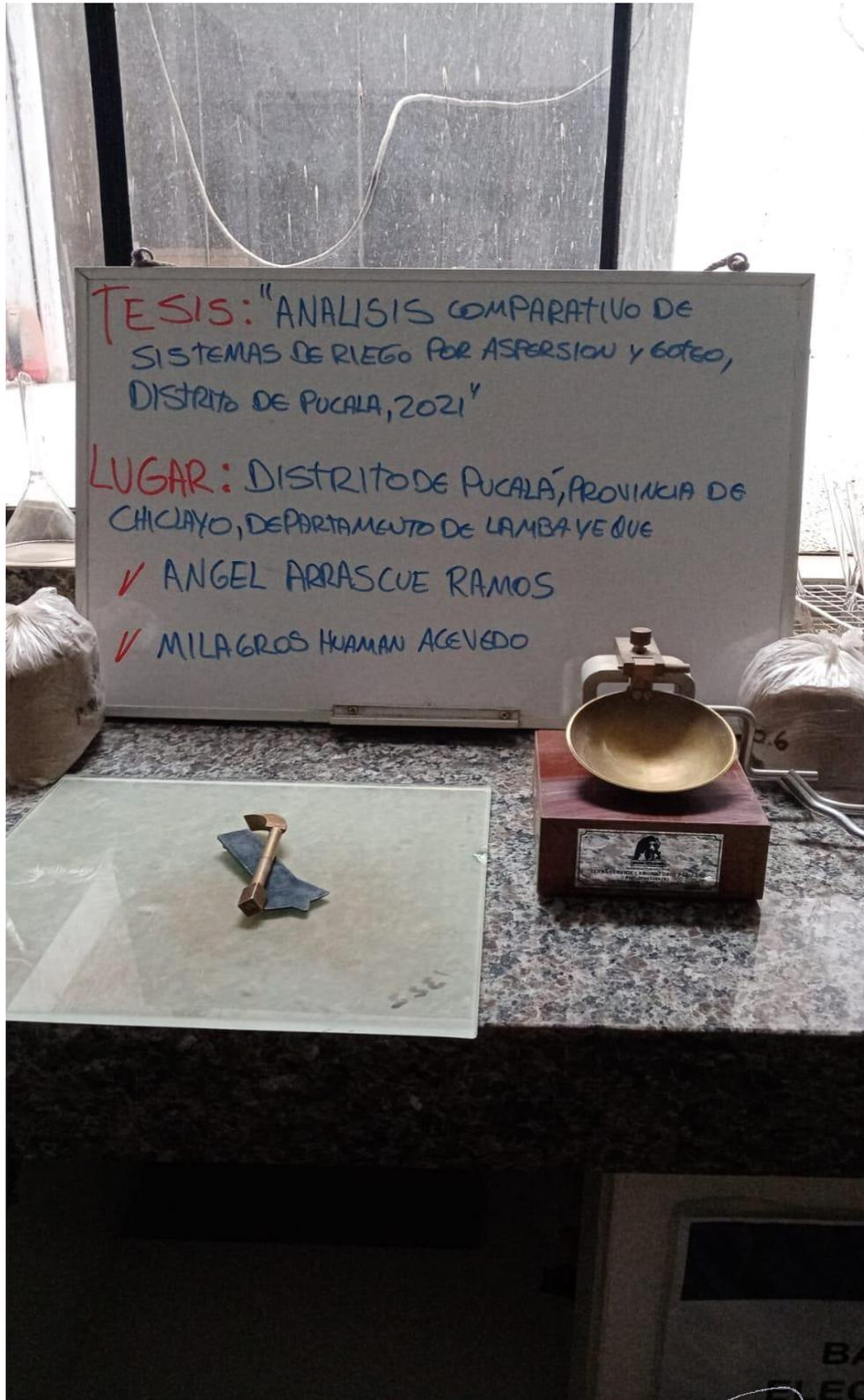
FOTOGRAFÍA N° 02: ENSAYO DE LÍMITE DE CONSISTENCIA
