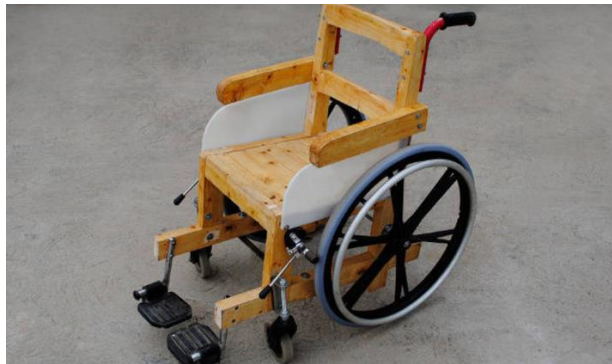
Figura 7: Silla de ruedas de madera adaptada por el usuario – Fuente propia
