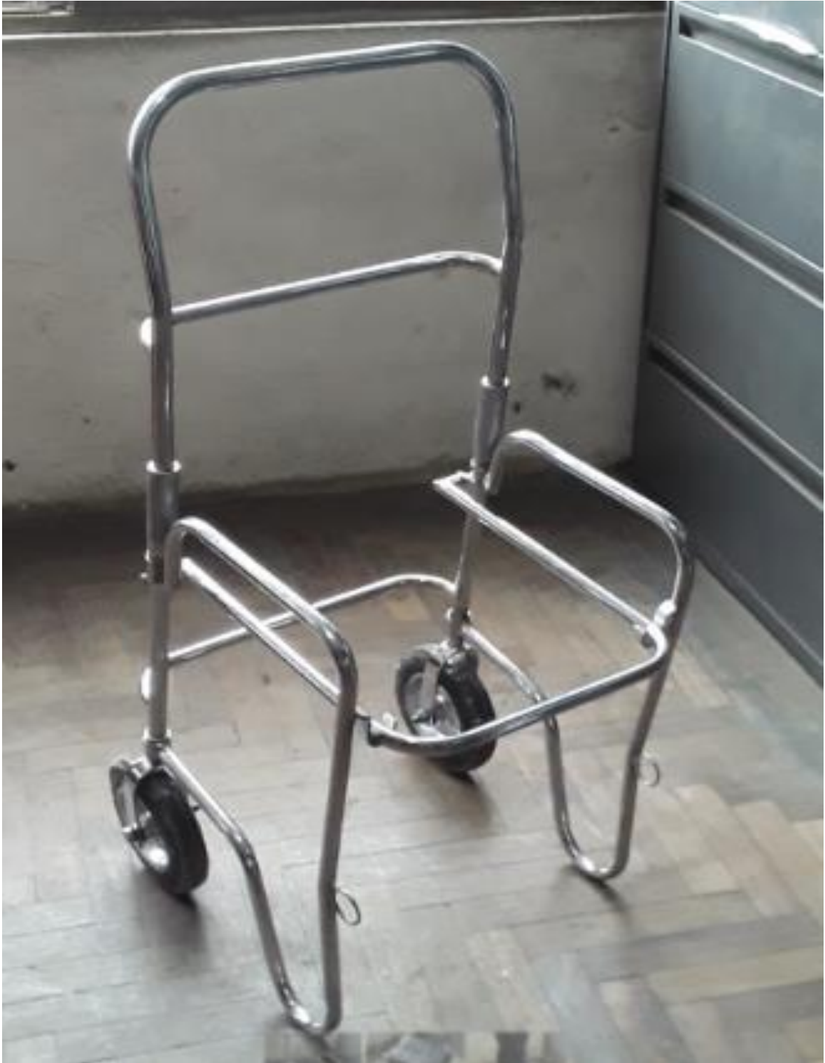
Anexo 11: Silla de ruedas plegable foto estructura
