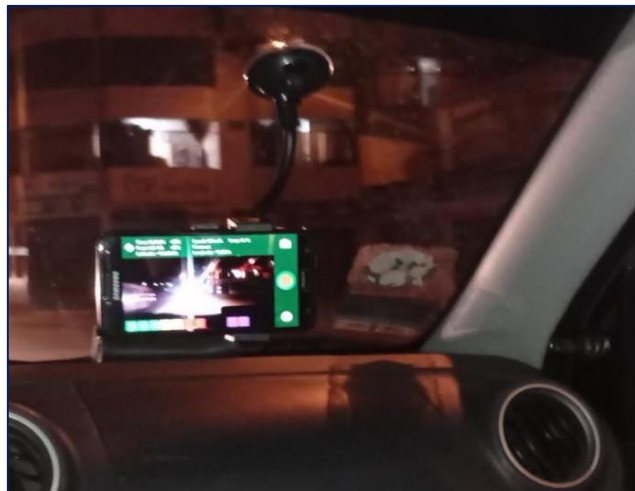
Figura 18: Instalación del sujetador con el Smartphone en el parabrisas del auto Fuente: elaboración por los autores
