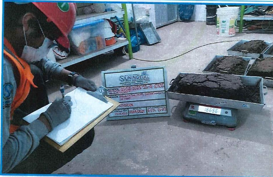
DESCRIPCIÓN: ABSORCIÓN EN ADOBES CON MUCILAGO PESO FINAL , Se procede a pesar las muestras escurridas húmedas en una balanza con precisión de 1 g.
