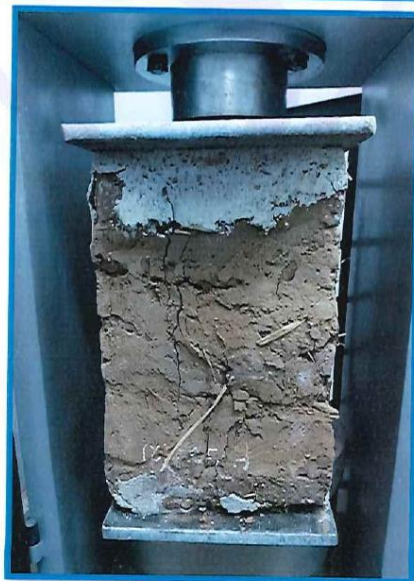
DESCRIPCIÓN: COMPRESIÓN AXIAL EN PRISMAS DE ADOBE CON MUCILAGO FALLA , Se puede apreciar la falla en nuestro espécimen ensayado.
