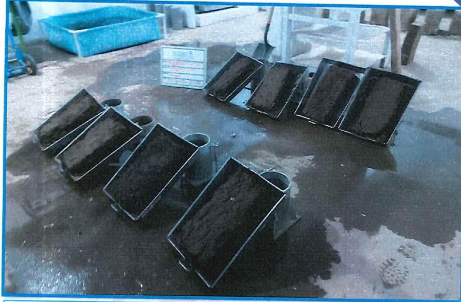
DESCRIPCIÓN: ABSORCIÓN EN ADOBES CON MUCILAGO ESCURRIDO , Se escurre la muestra hasta que el agua no esté visible en el espécimen por un tiempo de 20 min. aproximadamente
