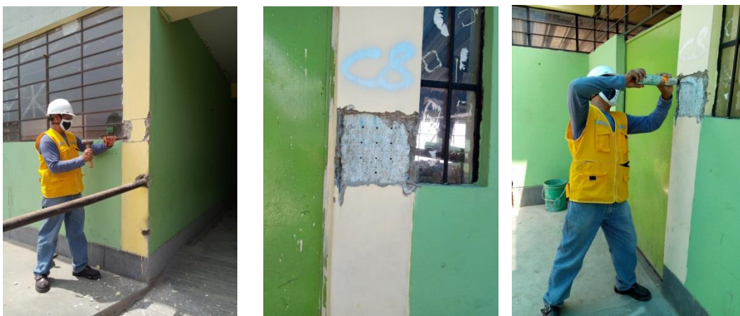
Procedimiento para el ensayo con Esclerometría. Fuente propia
