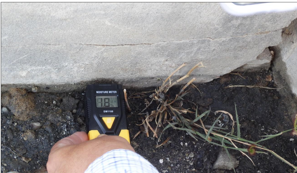
Figura 10 Registrando el porcentaje de humedad con equipo de medición
