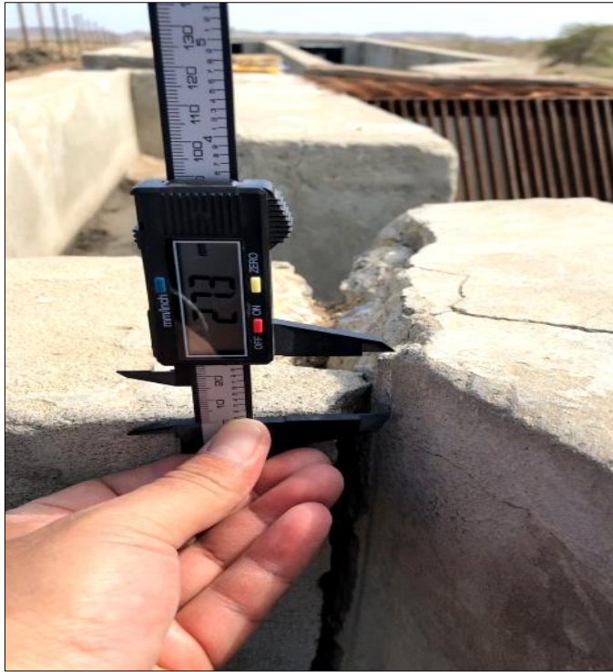
Figura 11 Registrando la profundidad del hundimiento con vernier digital
