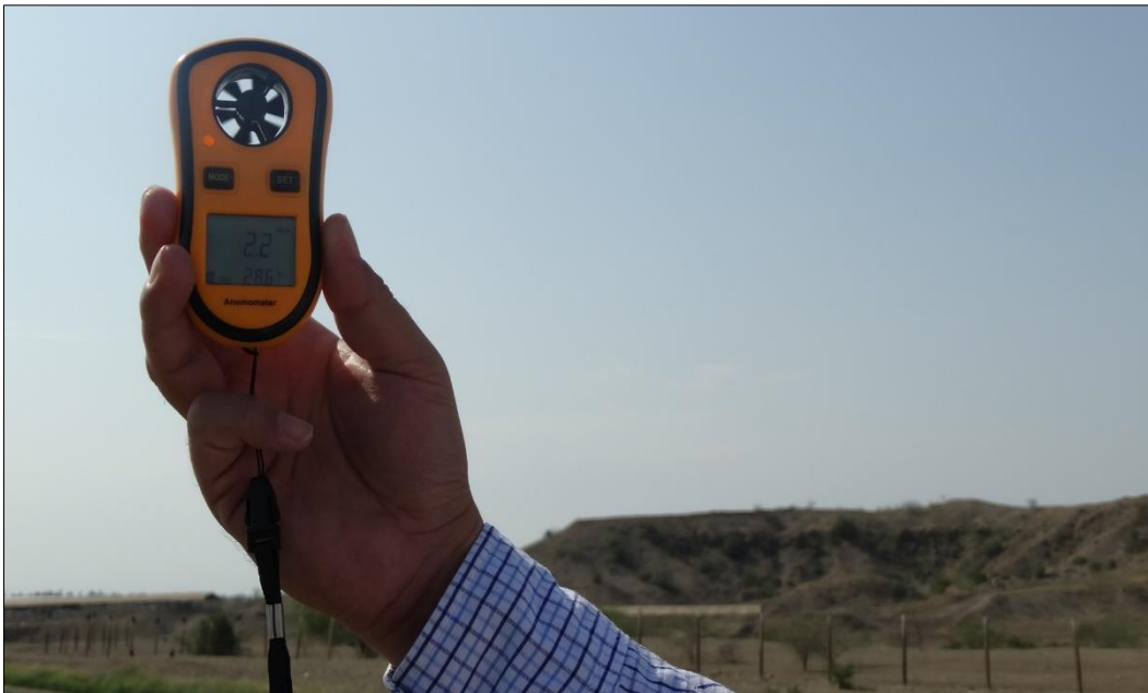
Figura 4 Toma de la velocidad del viento y la temperatura con anemómetro
