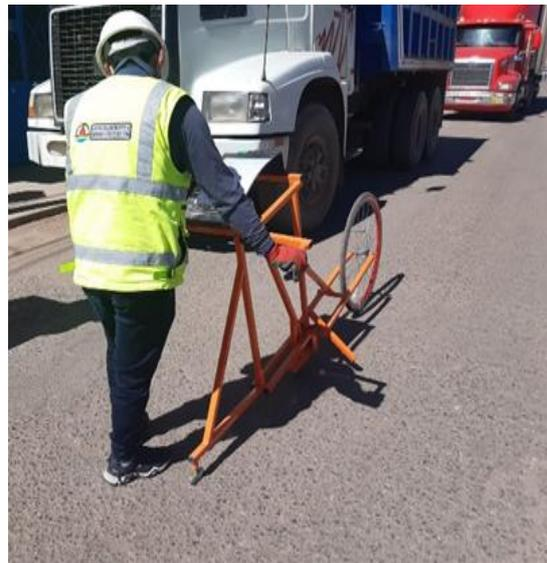
Ensayo de Rugosimetro de Merlín en el carril izquierdo, km 2+500.
