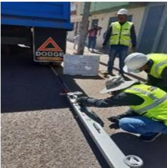
Ensayo de Viga Benkelman en el carril derecho en el km 1+200.
