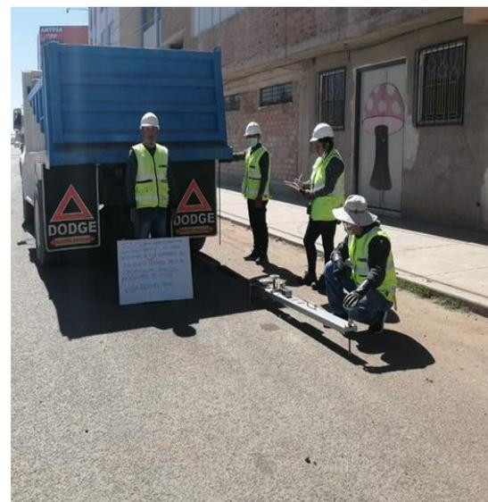
Ensayo de Viga Benkelman el carril izquierdo, km 2+750.
