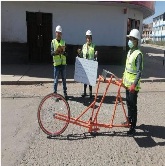
Ensayo de Rugosimetro de Merlín en el carril derecho en el km 0+800.
