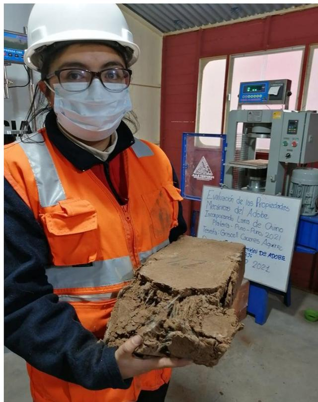
Figura N°17: Ejecución del ensayo de flexión del adobe
