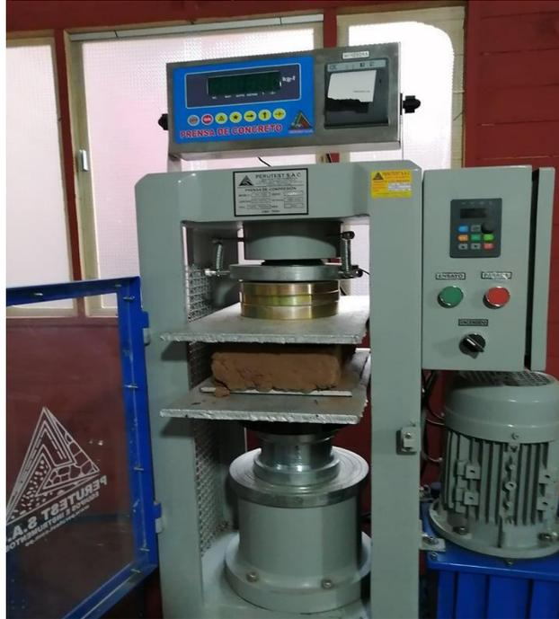
Figura N<sup>o</sup>16: Muestra de adobe después del ensayo de resistencia a compresión
