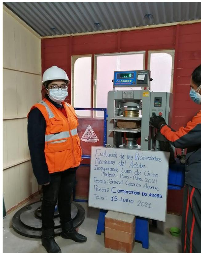
Figura N<sup>o</sup> 15: Ejecución del ensayo a compresión de los bloques de adobe.
