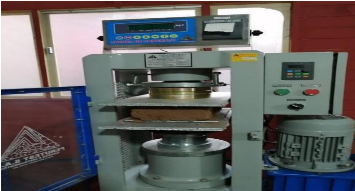
**Figura 5. Ensayo de Resistencia a la Compresión**
