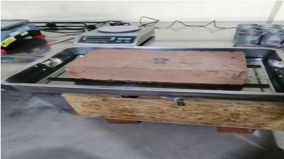
**Figura 8.** *Prueba en Laboratorio del Ensayo de Succión*
