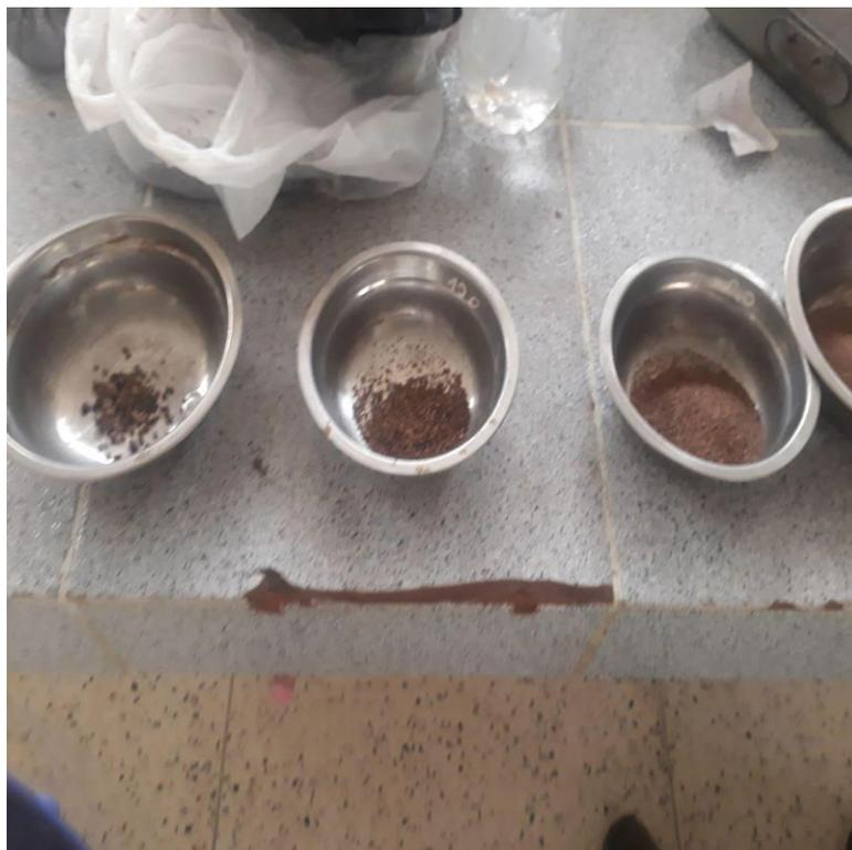
Figura N°05: Ejecución del ensayo de Limite Liquido
