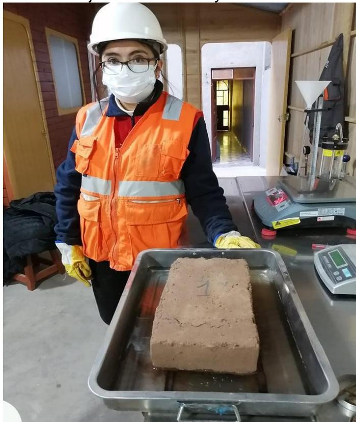
Figura N°21: Peso del adobe después de 1 minuto del ensayo de succión
