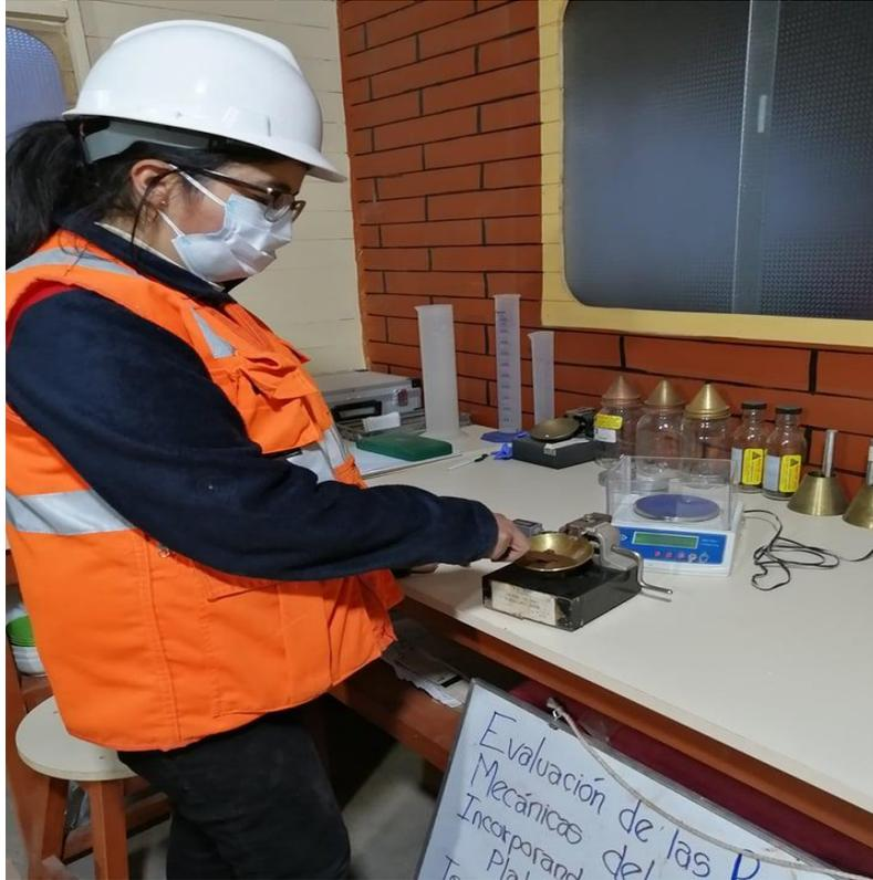
Figura N°06: Muestras del límite líquido y plástico en horno
