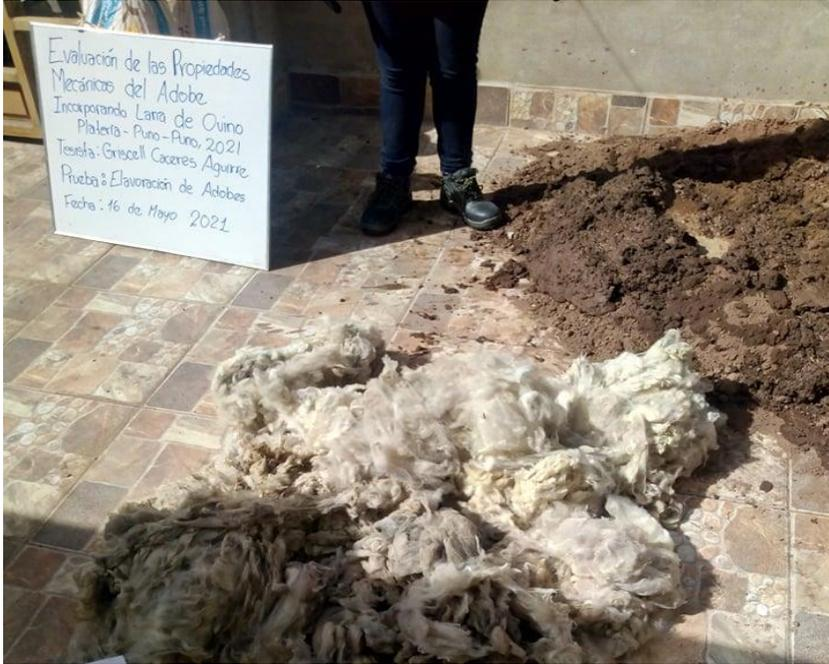
Figura N°08: Mezcla de la tierra y lana de ovino
