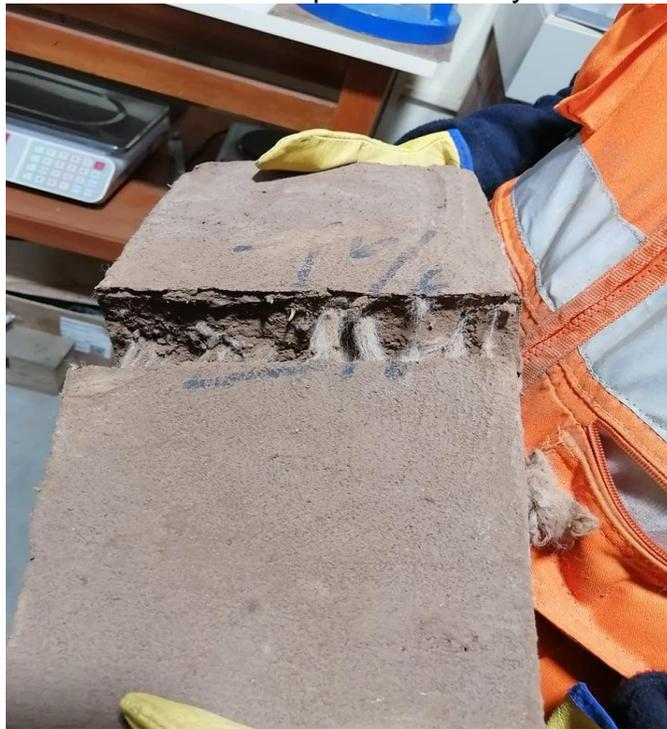
Figura N° 20: Ejecución del ensayo de succión del adobe
