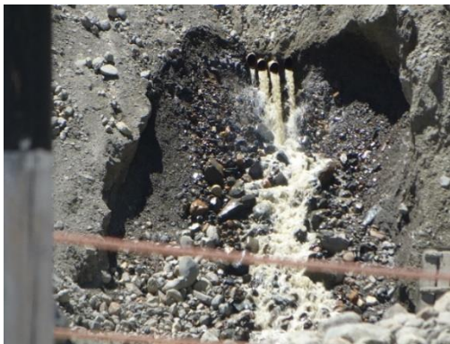
Figura 25: Conductos de efluentes mineros.
