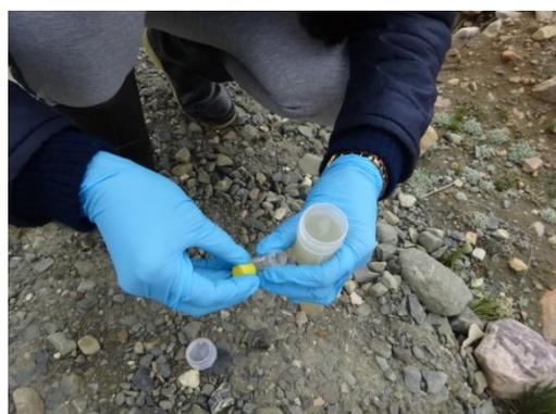
Figura 21: Adición del preservante a la muestra –  $\text{HNO}_3$  para su conservación.
