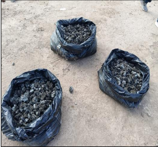
Figura 13. Lodos de PTAR
