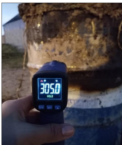
Figura 8. Control de temperatura con pirómetro
