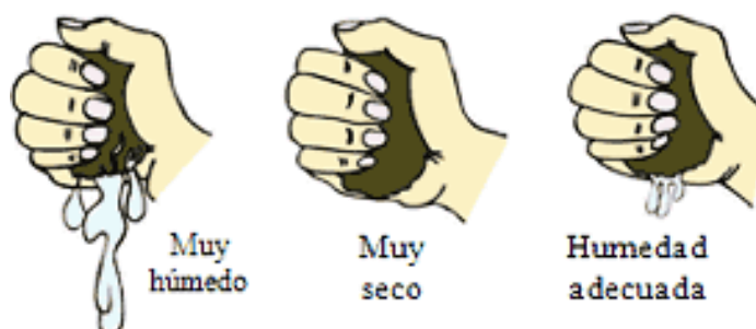
Figura 2. Test del puño de izquierda a derecha: Demasiado húmedo, demasiado seco y una buena humedad (Torti et al, 2019).
