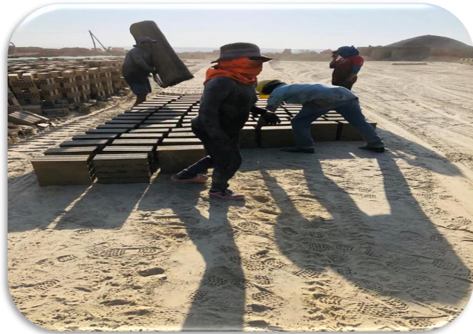
Figura 13: Personal transportando y acomodando ladrillos en zona de secado.
