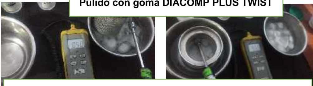
Termociclado de 500 ciclos en 5 y 55 °C
