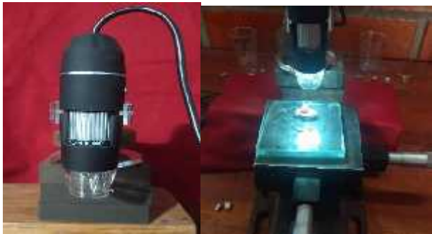
Muestras colocadas en el estereomicroscopio óptico digital USB con zoom (50x)
