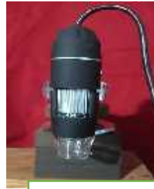
Estereomicroscopio óptico digital USB con zoom (50x)
