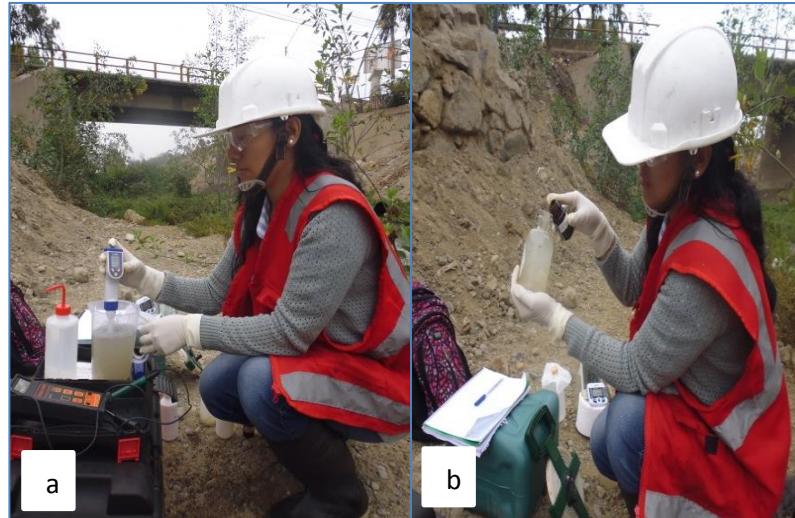
Figuras 6. (a) Medición de conductividad eléctrica in situ (b) Toma de muestra inicial para el oxígeno disuelto
