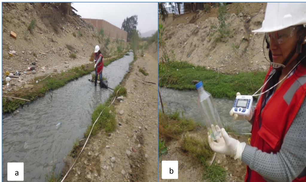
Figuras 9. (a) Medición del caudal del afluente Huaycoloro (b) Aplicación del método del frasco flotador
