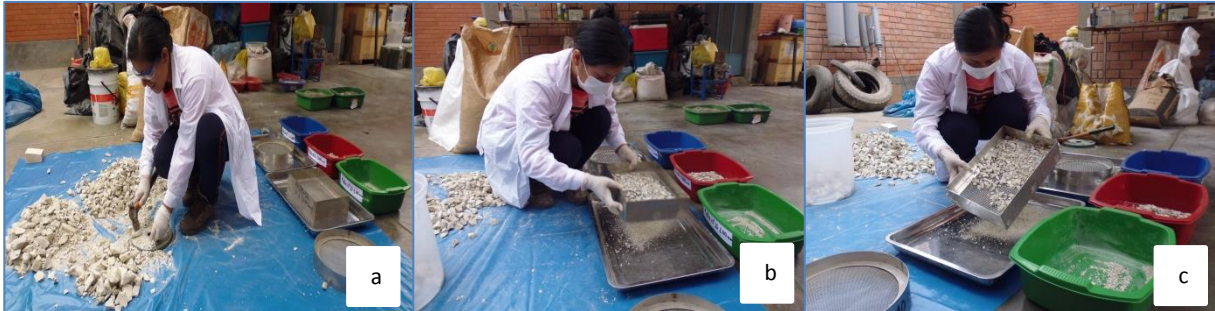
Figura 19. (a), (b) y (c) Procedimiento de clasificación de arcilla utilizando la granulometría
