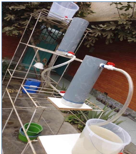
Figura 21. Filtro construido para el tratamiento de aguas del afluente Huaycoloro
