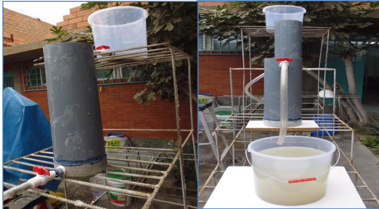
Figura 23. Tratamiento del agua del afluente Huaycoloro con arcilla-bentonita
