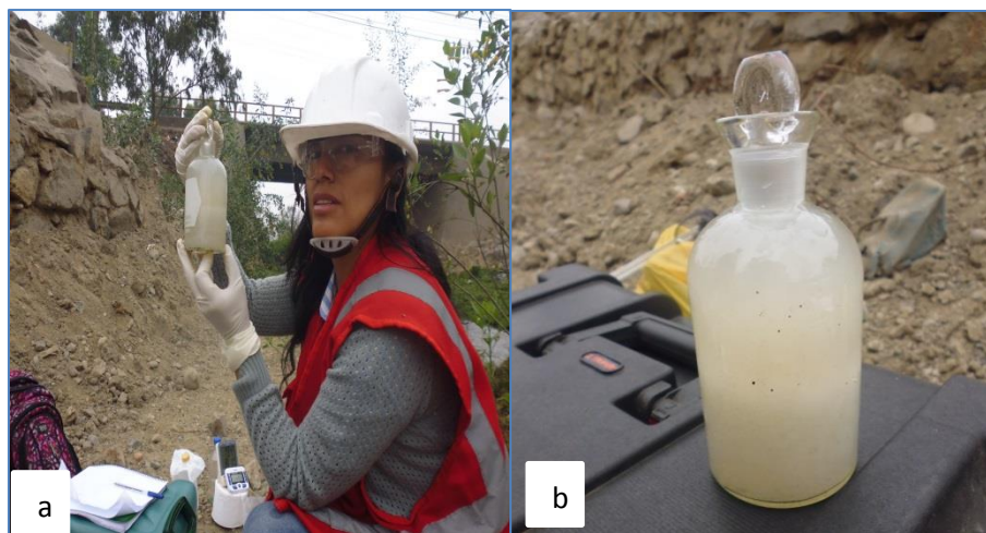
Figura 7. (a) Medición del parámetro oxígeno disuelto in situ (b) Muestra de oxígeno disuelto al laboratorio para su análisis.
