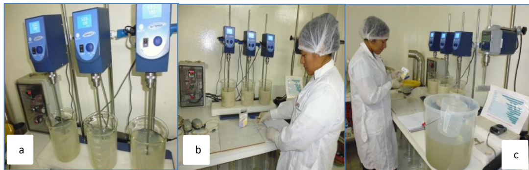
Figura 27. (a),(b) y (c) Prueba del test de jarras para el tratamiento de reducción de As
