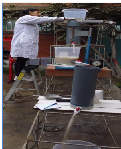
Figura 33. Tratamiento final con Arcillas modificadas
