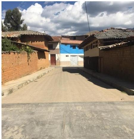
Nota. La siguiente imagen muestra una tipología de vivienda de dos niveles debido a que la construcción con adobe no permite obtener una mayor altura, ni edificar una moderada cantidad de vanos, tanto en paredes, puertas y ventanas. La altura de las paredes no puede exceder el ancho de cada ambiente interior, a fin de adquirir una vivienda más estable y resistente.
