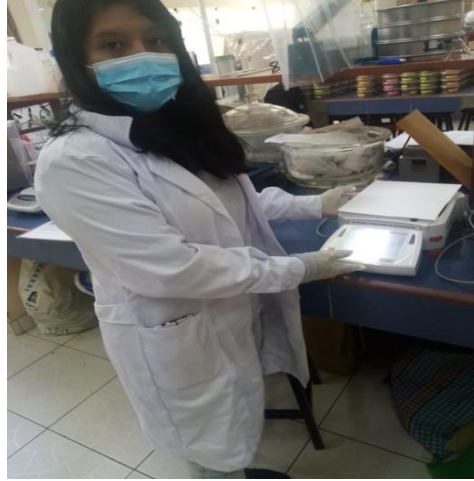
Figura 5. Pesado inicial y final del filtro de cuarzo para la medición del material particulado PM10 y PM2.5.
