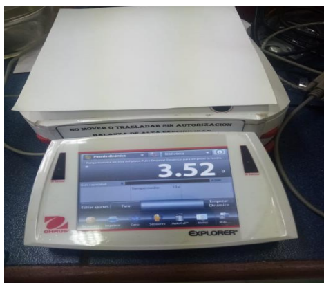
Figura 7. Balanza analítica donde se realizó el pesaje de los filtros de cuarzo de PM 10 y PM 2.5
