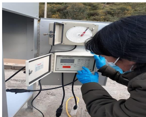
Figura 4. Programación para la calibración del Hi-vol de flujo de alto volumen
