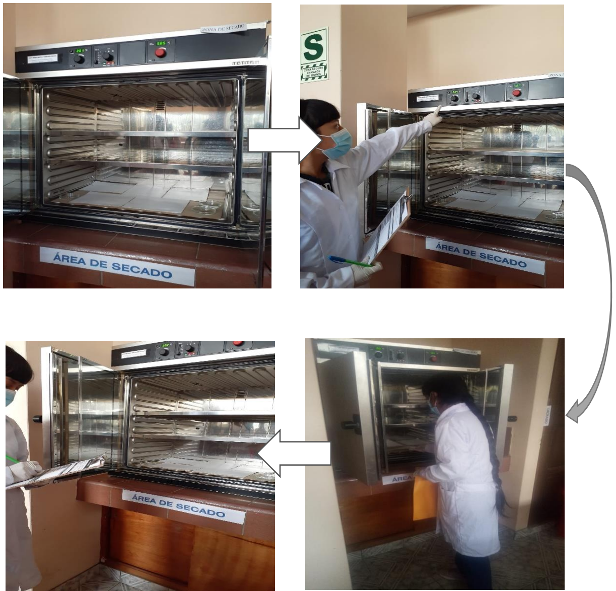
Foto 1 Acondicionamiento de filtros
