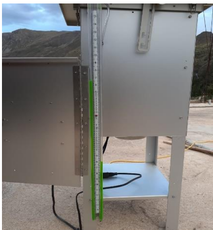
Figura 9. Medición del flujo mediante la regla por diferencia de presiones atmosféricas
