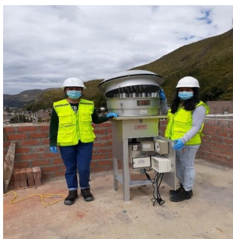
Figura 2. Instalación del equipo Hi-vol de flujo de alto volumen según el protocolo de monitoreo de aire para material suspendido.
