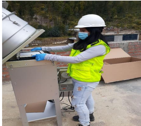
Figura 3. Instalación del filtro de cuarzo para la medición del material particulado
