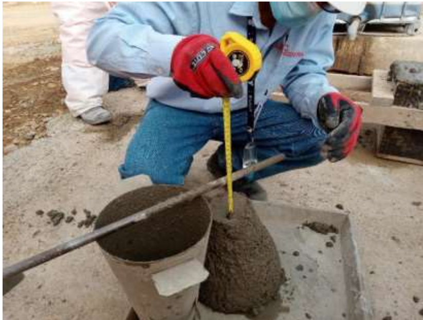
Figura 13 Prueba de asentamiento de la mezcla
