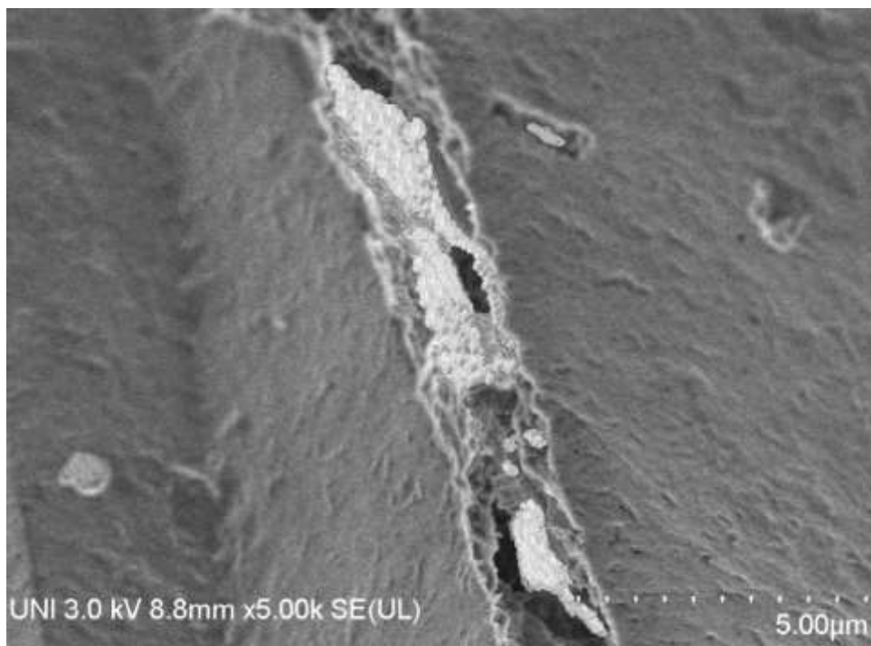
Figura 29 Microgrieta a los 14 días con ABC15-SEM
