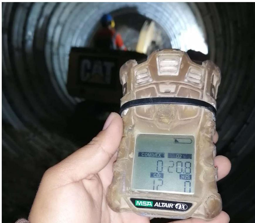
Toma de datos con el detector de gas Altair 4X, Oxigeno 20.8 ppm, CO 12 ppm, H2S 0 en el Túnel Liner 690 ml.
