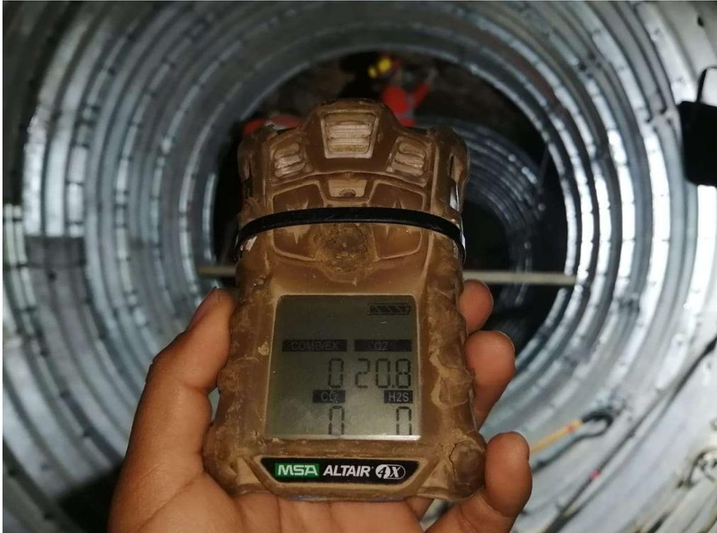
Toma de datos con el detector de gas Altair 4X, Oxigeno 20.8 ppm, Túnel Liner 690 ml.
