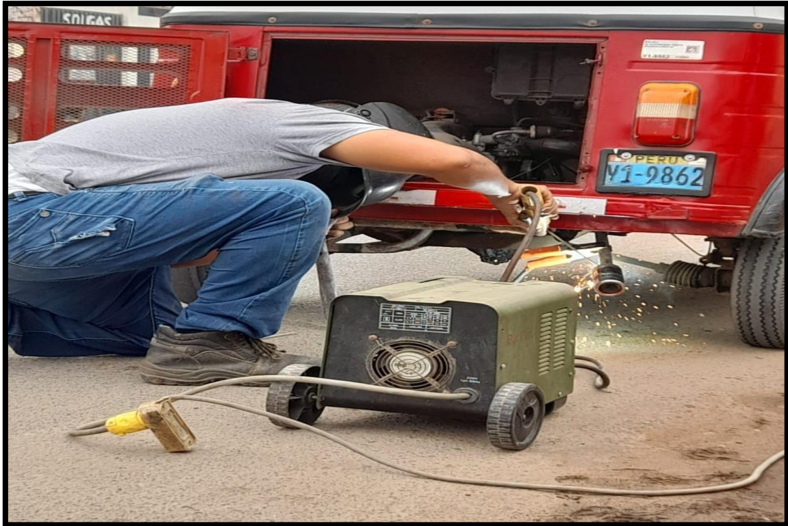
Ilustración 21: Implementación del filtro al tubo de escape.
