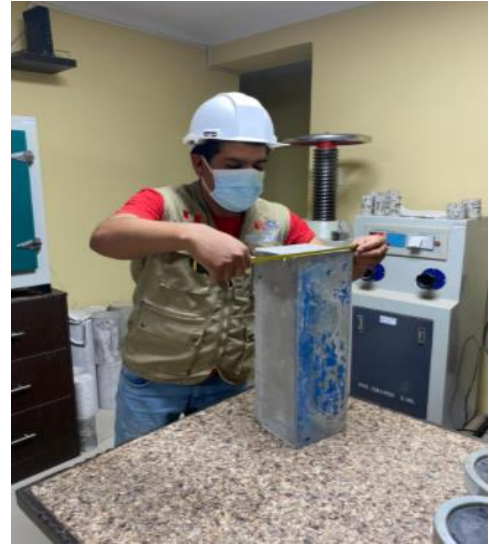
Medición de dimensiones de probeta a flexión
