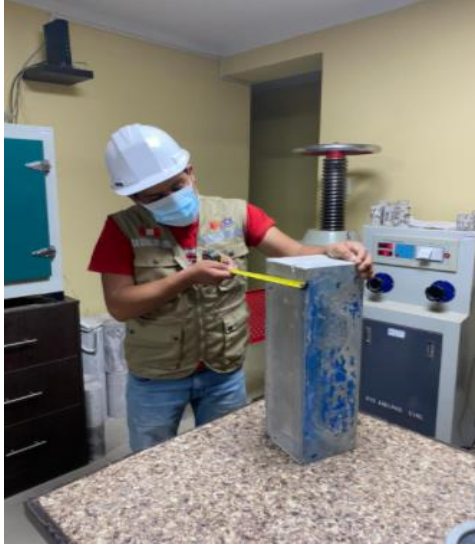
Medición de dimensiones de probeta a flexión
