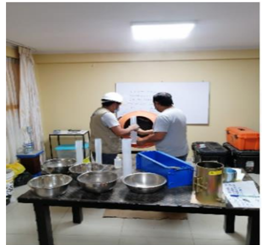
Fabricación de probetas prismáticas y cilíndricas
