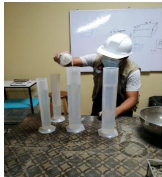
Medición de cantidad de agua para fabricación de probetas
