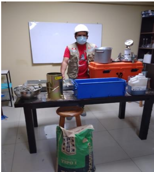
Materiales para la fabricación de probetas
