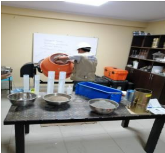
Fabricación de probetas prismáticas y cilíndricas
