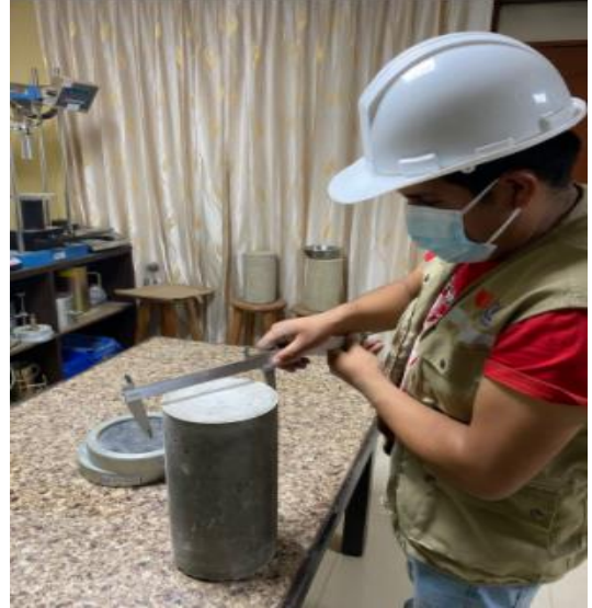
Medición de dimensiones de probeta a compresión
