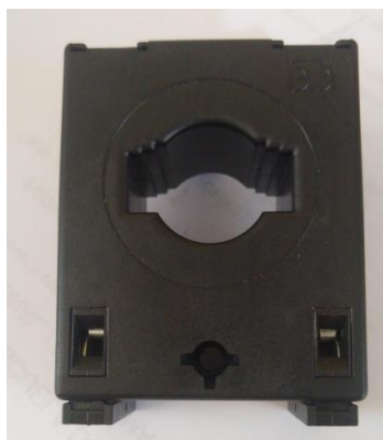
Figura : 9 , Transformador de Corriente Fuente: Elaboración Propia, 2021
