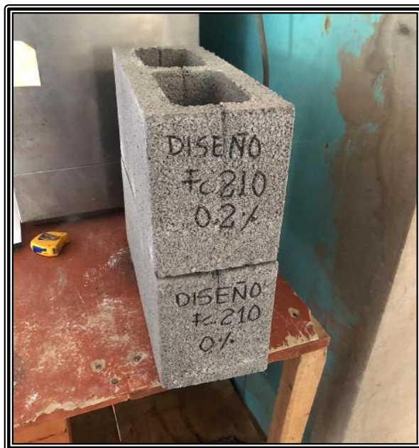
Imagen N° 12: Diseño de bloque de concreto por dosificación 0%, 0.2%.
