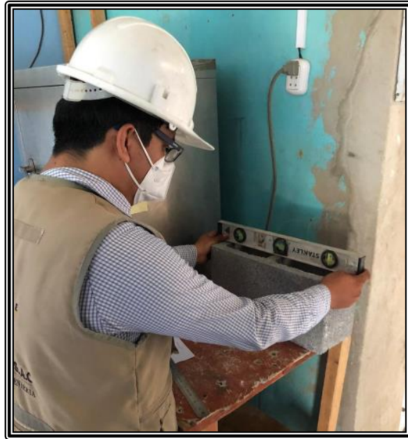
Imagen N° 07: En este punto se puede observar la ejecución del ensayo de alabeo y absorción del bloque de concreto.
