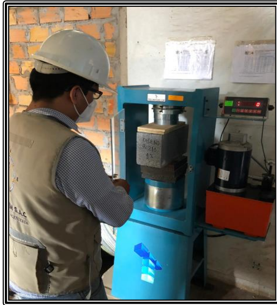
Imagen N° 13: En esta imagen podemos observar la rotura del diseño de bloque de concreto 0%, 0.2%.
