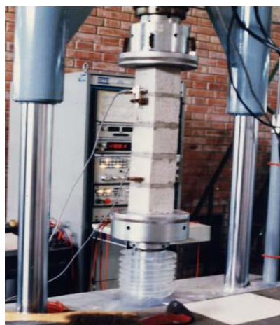
Imagen 05: pilar de bloques de concreto sujetas a compresión.
