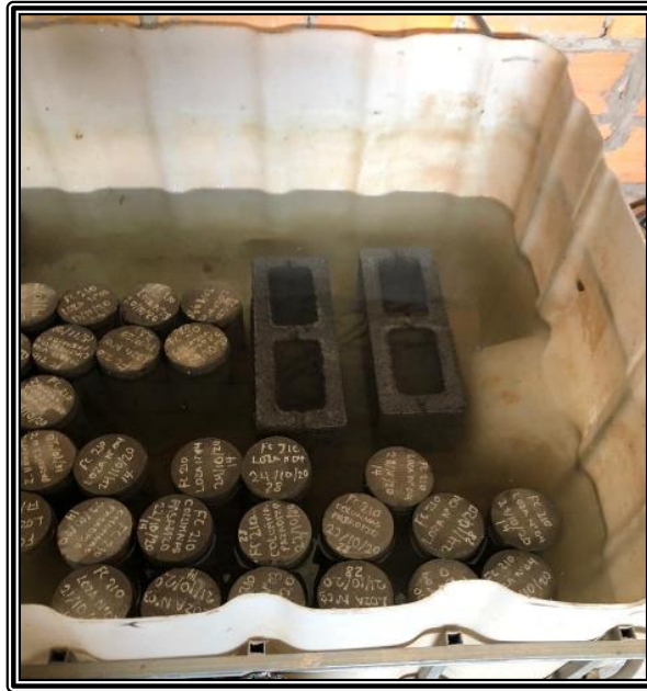
Imagen N° 11: En esta imagen se puede apreciar el curado de los bloques de concreto y reposo de los mismos.
