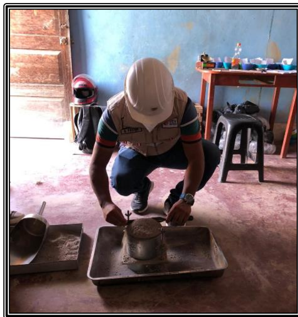
Imagen N° 06: En esta imagen se puede observar el ensayo de peso unitario.
