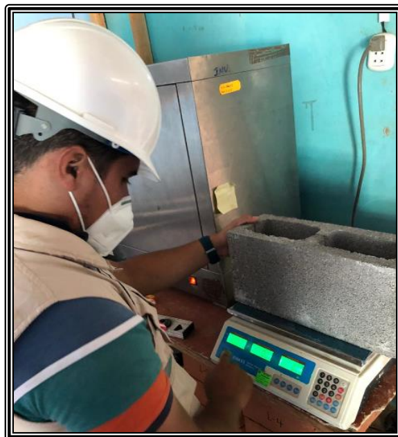
Imagen N° 08: En esta imagen se está haciendo el ensayo de alabeo y el peso del bloque de concreto.
