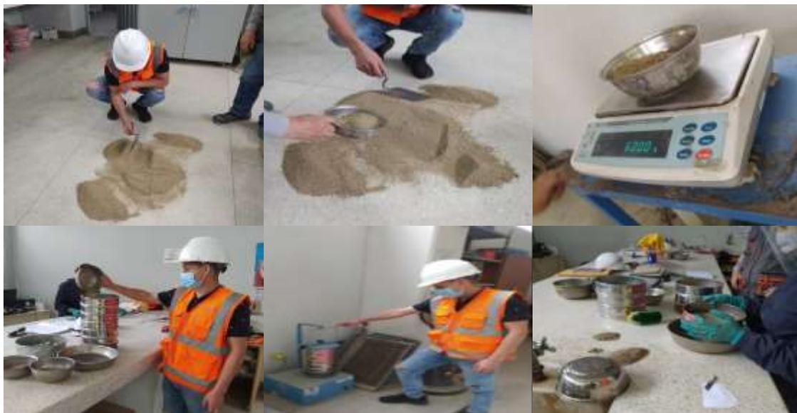
Figura 5. Equipos y procedimiento de granulometría
