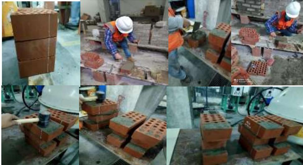
*Figura 24. Humedecer el ladrillo; tipo H de 3 unidades cruzadas de albañilería con mortero convencional de ladrillos Tipo A, nivelación.*
