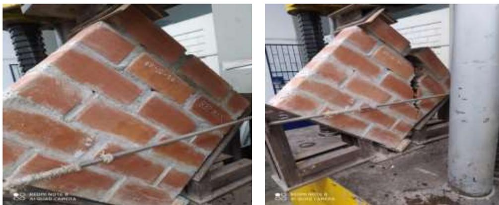
*Figura 22.* Ensayo de corte diagonal de muretes con mortero Rapimix
