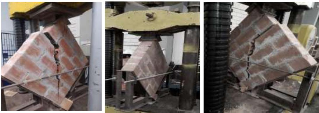
*Figura 21.* Ensayo de corte diagonal de muretes con mortero tradicional.
