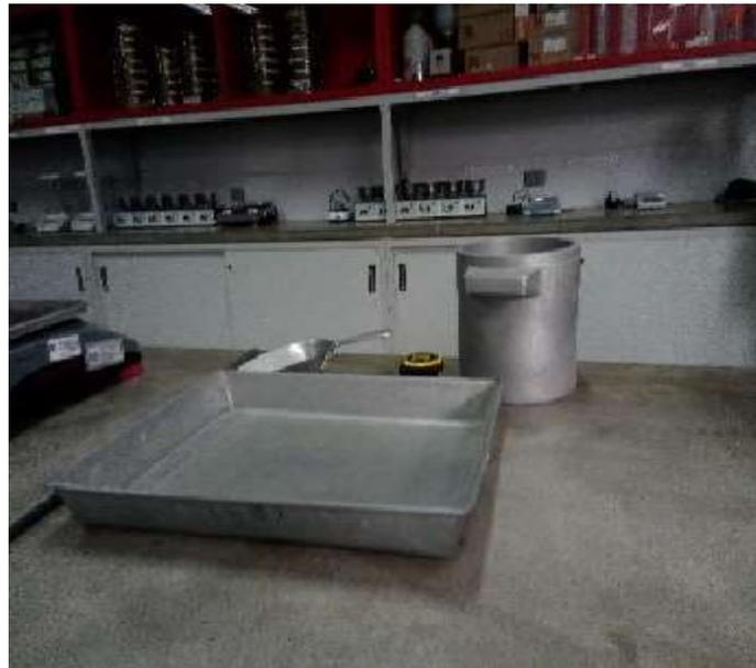
*Figura 07.* Equipos y procesamiento de peso unitario suelto agregado fino Fuente: fotos propias
