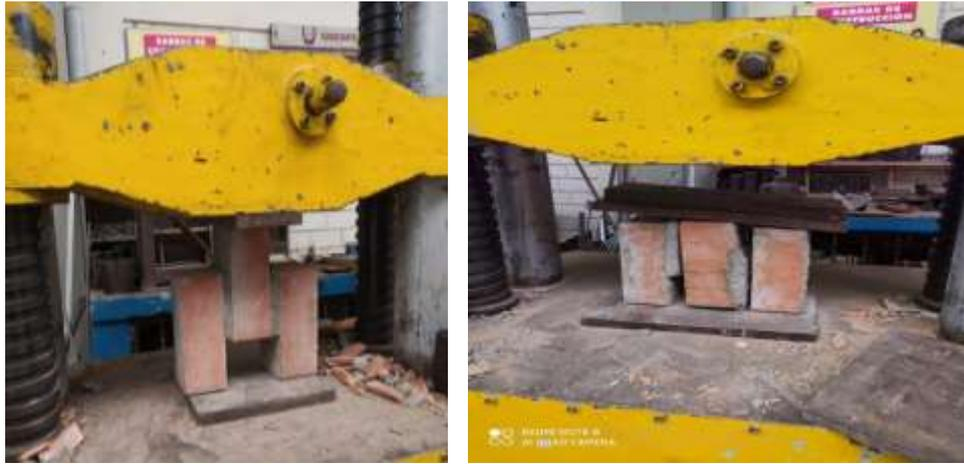
Figura 26. Se muestra el procedimiento del ensayo de adherencia con mortero convencional. Fuente: Fotos propias
