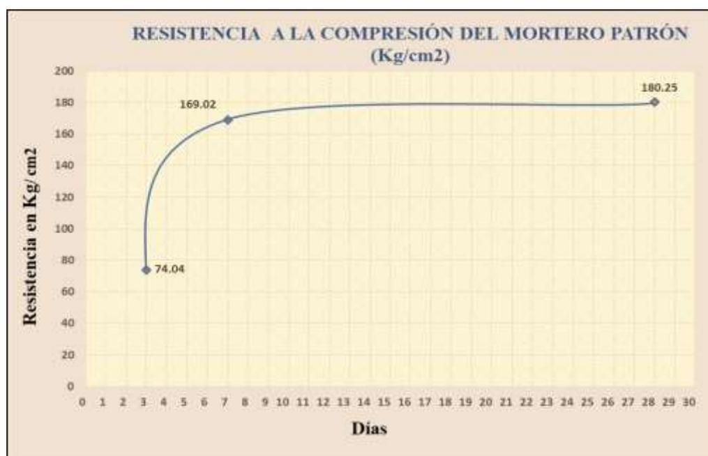
Figura 13. Resistencia a la compresión en cubos de mortero.
