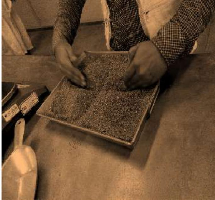
*Figura 08. Proceso para el P.U.C. del agregado fino*
