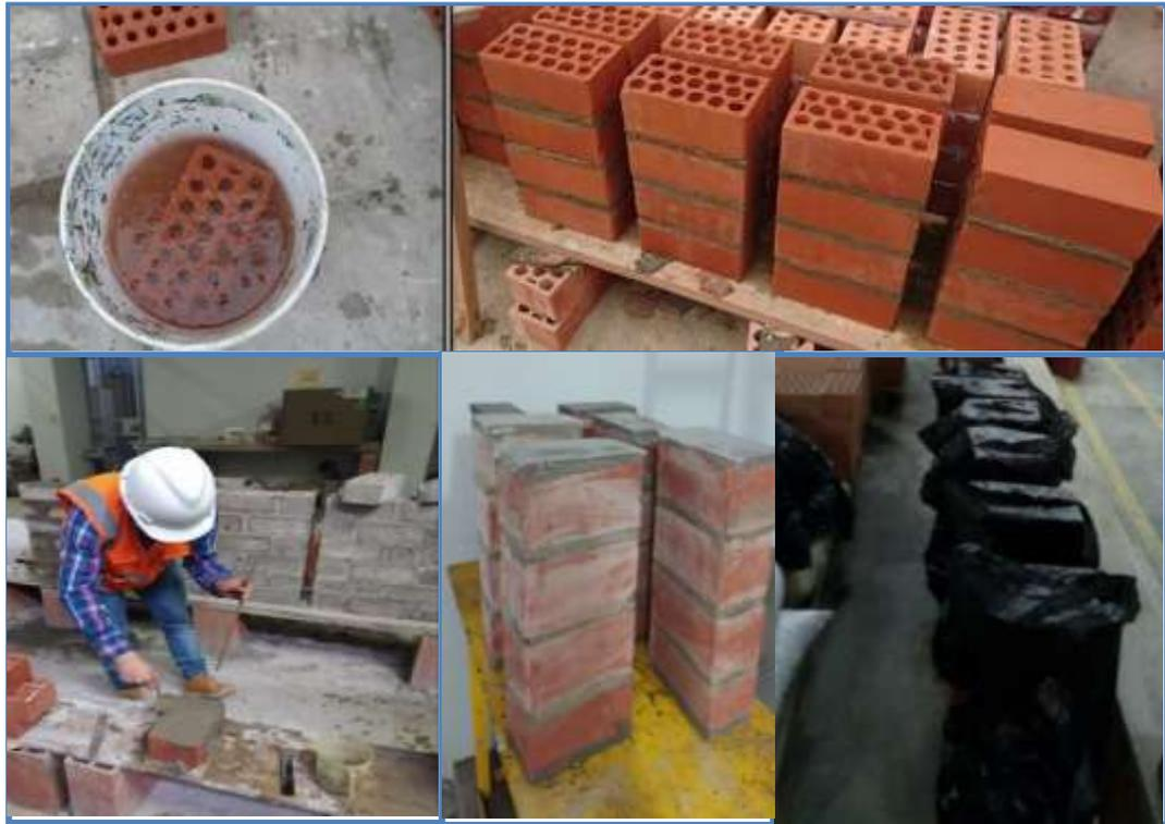
*Figura 14.* Humedecimiento del ladrillo; prismas de ladrillo con mortero convencional de ladrillos Tipo A, nivelación y cubierta con bolsa de polietileno.
