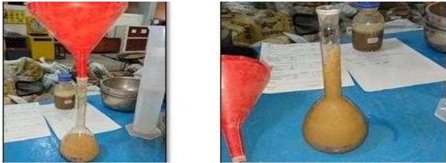
*Figura 09. Proceso para el peso específico y porcentaje de absorción Fuente: fotos propias*
