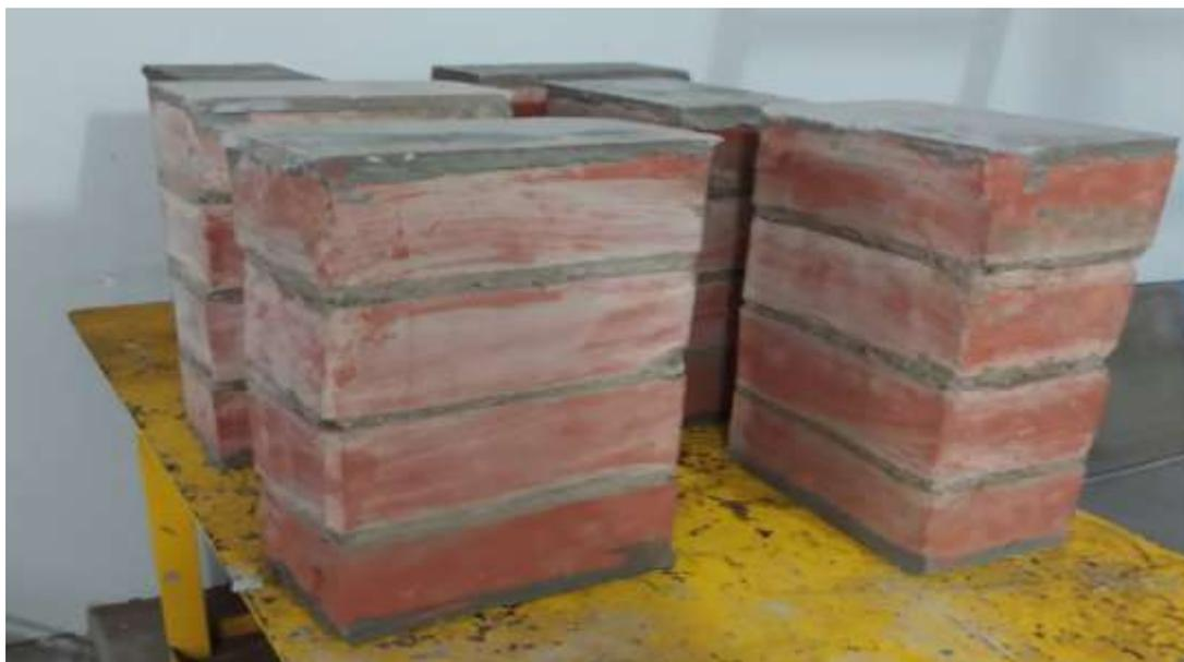
*Figura 15.* Podemos observar el procedimiento de aplicación del mortero “Rapimix” y la forma de aplicación en la elaboración de prismas empleando el ladrillo Tipo A,
