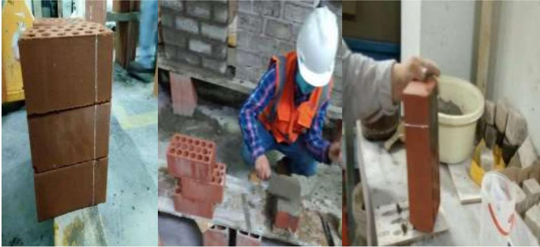
*Figura 25.* Rellenar con mortero la unidad de albañilería hasta 5 cm; Pilas tipo H de 3 unidades cruzadas de albañilería con mortero Rapimix con el ladrillo Tipo A, nivelación y cubierta con bolsa de polietileno
