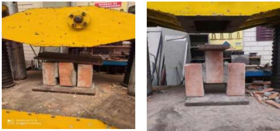
Figura 27. Se muestra el procedimiento del ensayo de adherencia con mortero Rapimix. Fuente: Fotos propias
