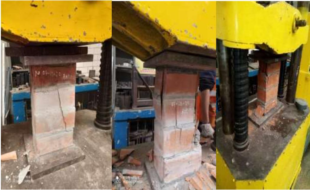
Figura 16. Toma de medidas; ensayo de compresión axial de pilas con mortero tradicional y mortero Rapimix del ladrillo Tipo A.
