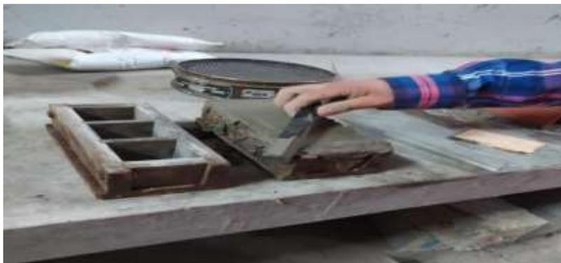
*Figura 11.* Especímenes de mortero.
