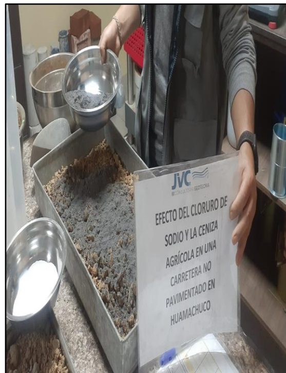
11.- Cloruro de sodio y ceniza agrícola para los ensayos de laboratorio con sus proporciones ya mencionadas anteriormente.
