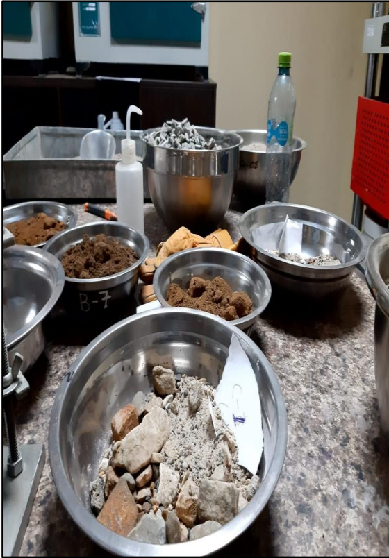
9.- Clasificaciones de suelos después de realizar el análisis granulométrico de la muestra de suelo
