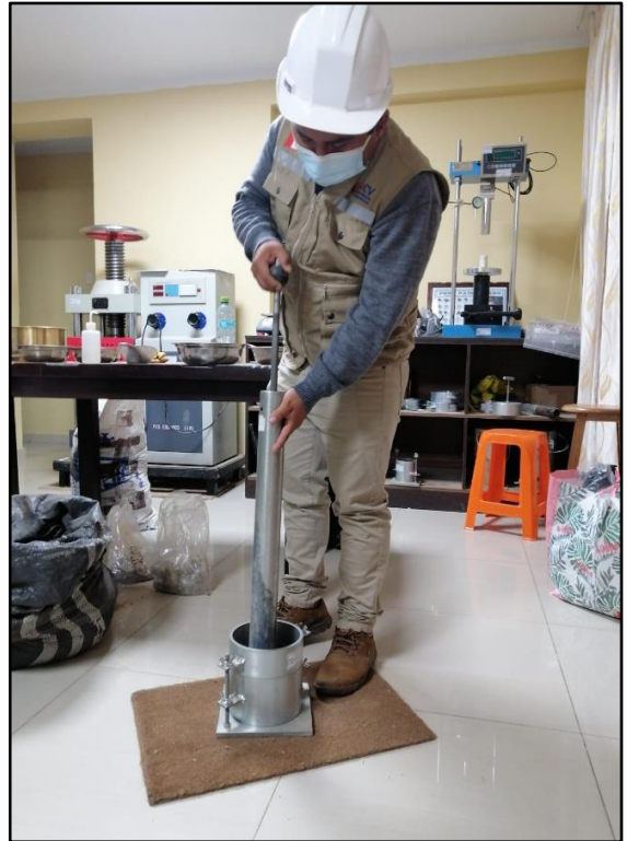
10.- Realizamos el ensayo de Proctor Modificado y CBR a cada muestra de suelo
