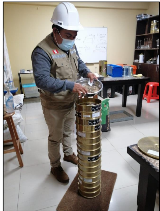
8.- Realizando el análisis granulométrico mediante el tamizado de las muestras.
