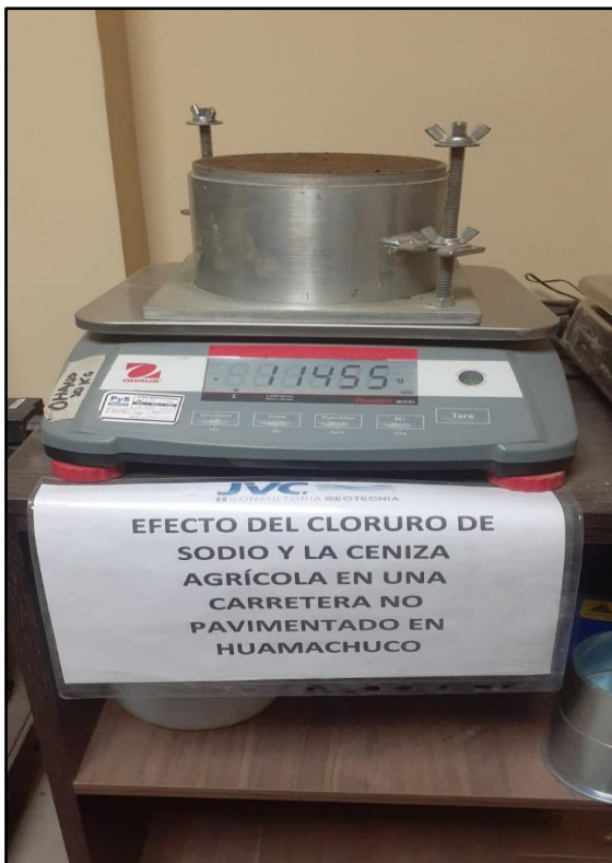
14.- Se realiza el ensayo de Proctor modificado y CBR con adición de cloruro de sodio y ceniza agrícola de las muestras.
