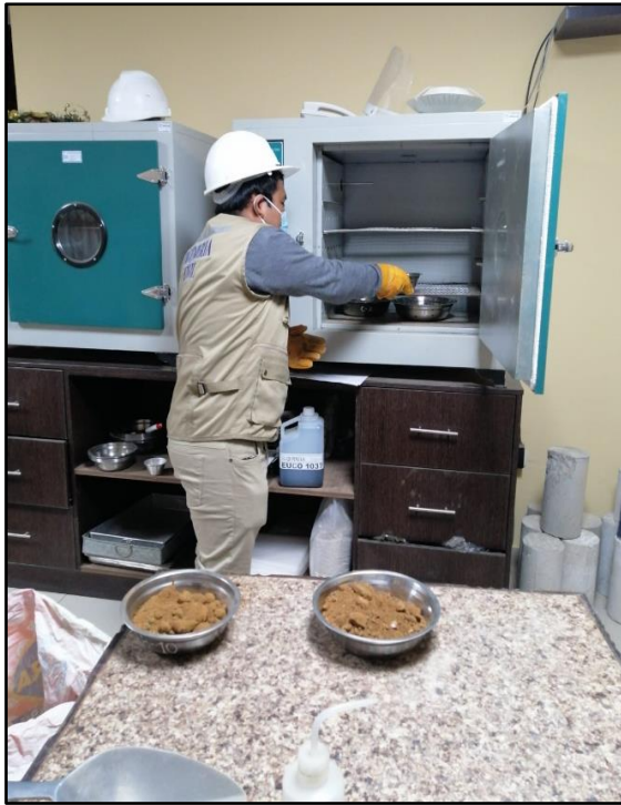
7.- Determinación del contenido de humedad natural de la muestra de suelo por la técnica de secado en el horno
