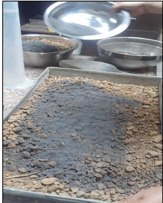
13.- Se procede añadir el cloruro de sodio y ceniza agrícola para los ensayos respectivos.
