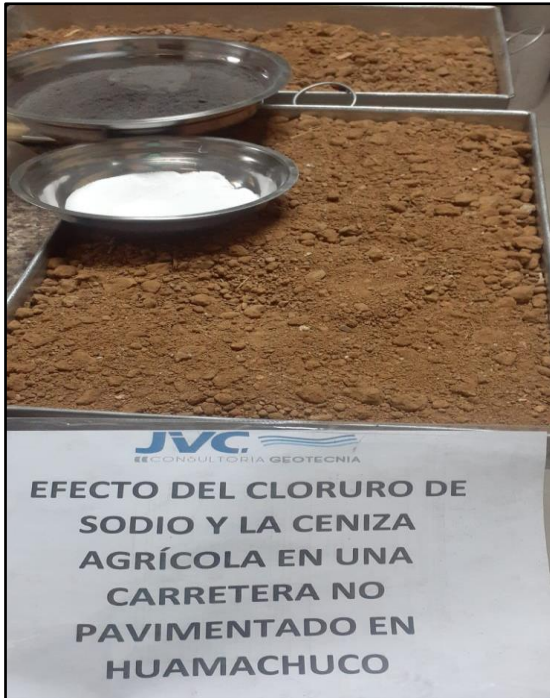
13.- Se procede añadir el cloruro de sodio y ceniza agrícola para los ensayos respectivos.
