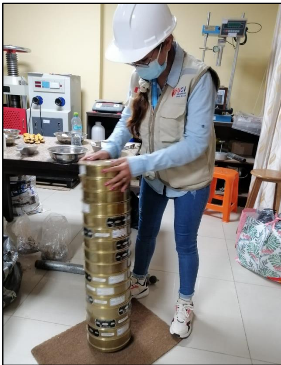
8.- Realizando el análisis granulométrico mediante el tamizado de las muestras.
