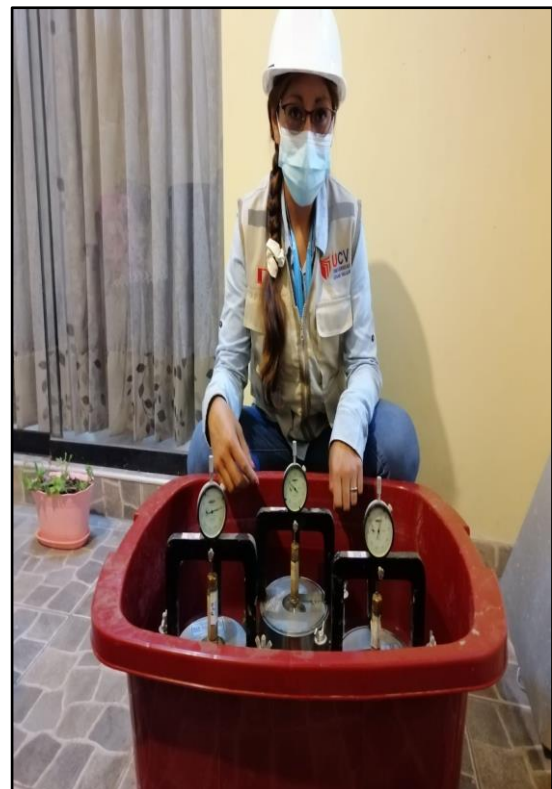
14.- Se realiza el ensayo de Proctor modificado y CBR con adición de cloruro de sodio y ceniza agrícola de las muestras.
