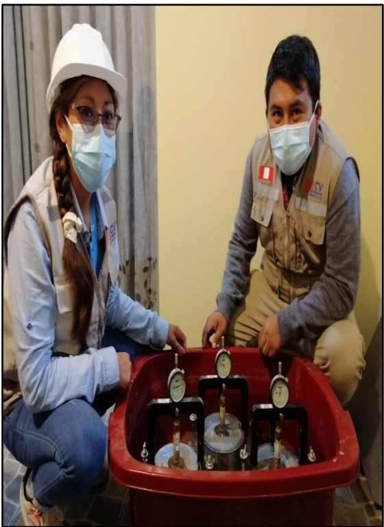
10.- Realizamos el ensayo de Proctor Modificado y CBR a cada muestra de suelo
