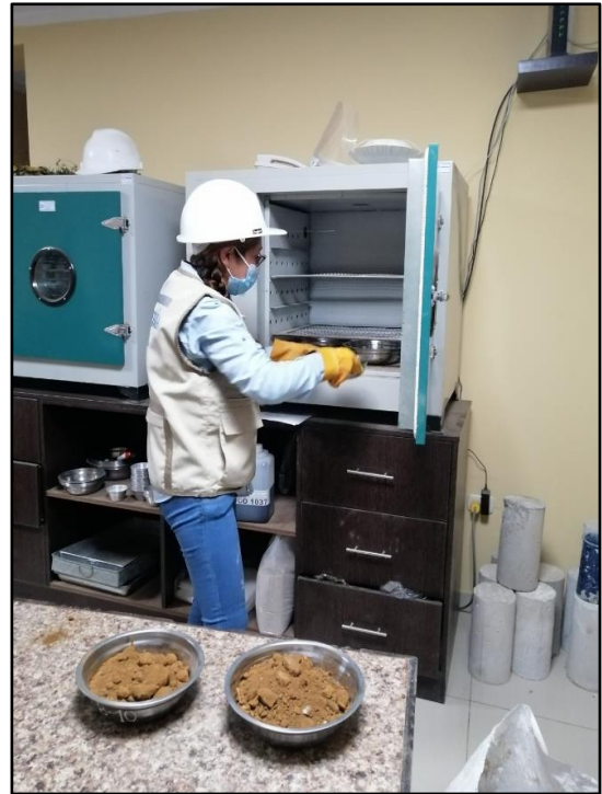
7.- Determinación del contenido de humedad natural de la muestra de suelo por la técnica de secado en el horno
