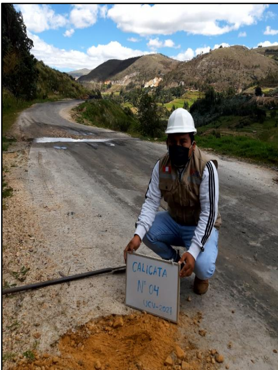
6.- Ubicación y excavación de las calicatas para la toma de muestras a una profundidad de 1.50 m
