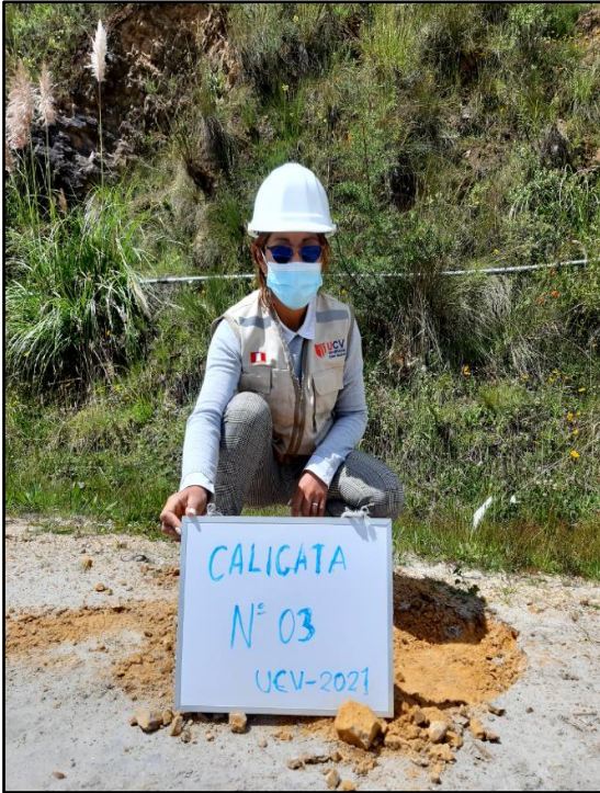
5.- Ubicación y excavación de las calicatas para la toma de muestras a una profundidad de 1.50 m
