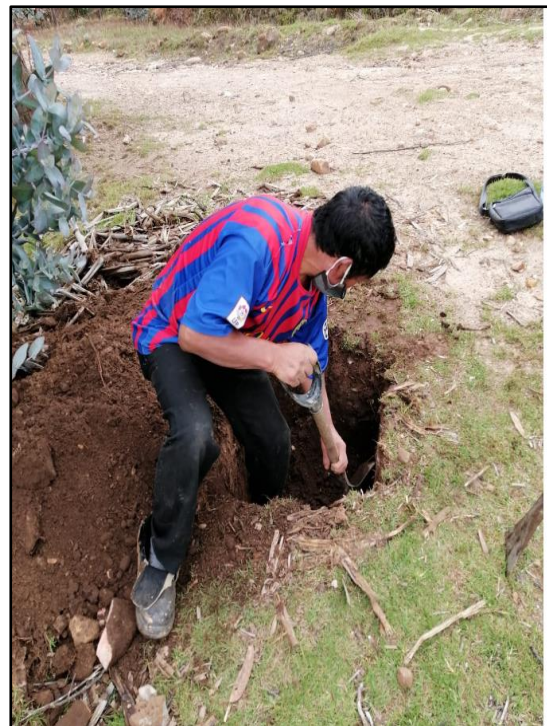
6.- Ubicación y excavación de las calicatas para la toma de muestras a una profundidad de 1.50 m
