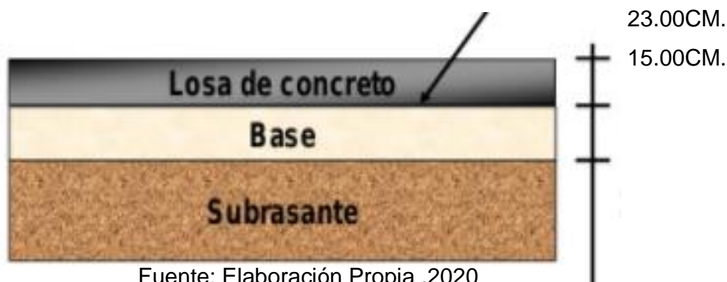
Gráfico 1: Sección transversal de vía
